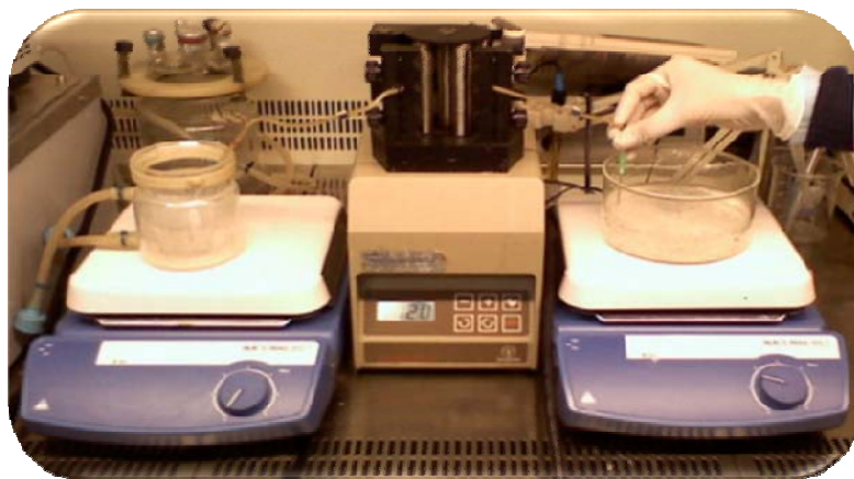
Figura 13. Esquema de la técnica de inmovilización por atrapamiento con soporte de alginato de sodio.
