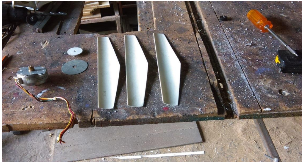
Figura 3.2 Elaboración de álabes de la turbina
