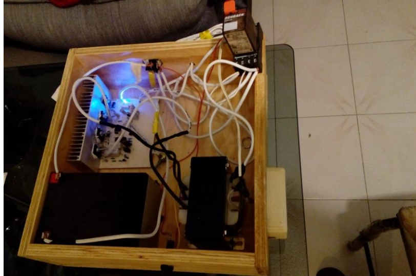
Figura 3.14 Circuito con relevador.
