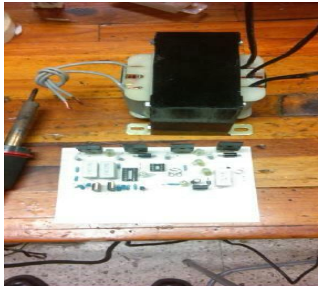
Figura 3.13 Transformador a 240 W.
