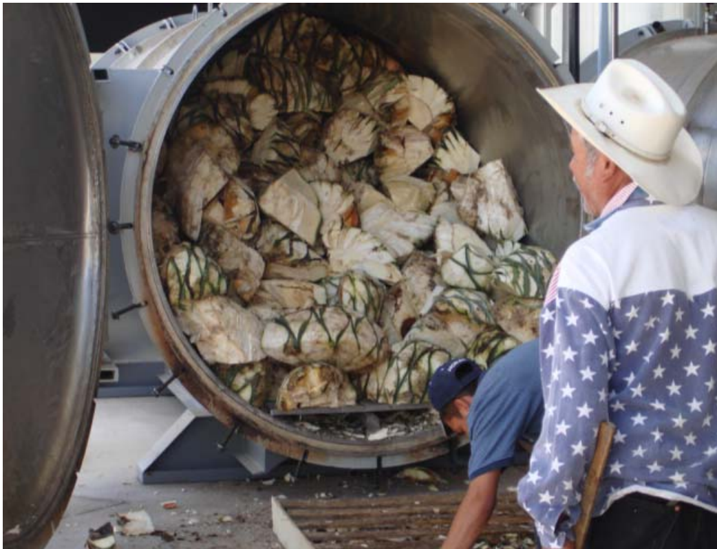
Figura 6. Piñas de Agave durangensis partidas y listas para cocerse en autoclaves de acero inoxidable (Fotografía: Vicente Hernández Vargas)
