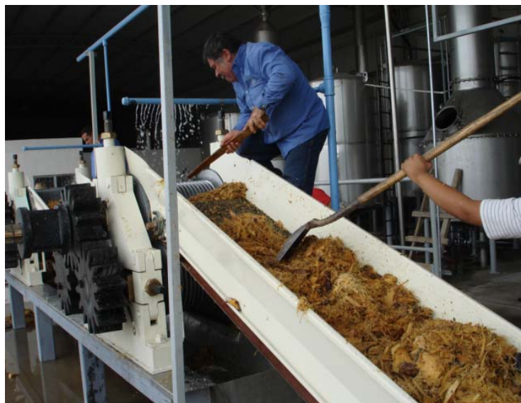
Figura 8. Prensa para triturar las piñas cocidas de agave de la planta destiladora de Nombre de Dios, Durango (Fotografía: Vicente Hernández Vargas)
