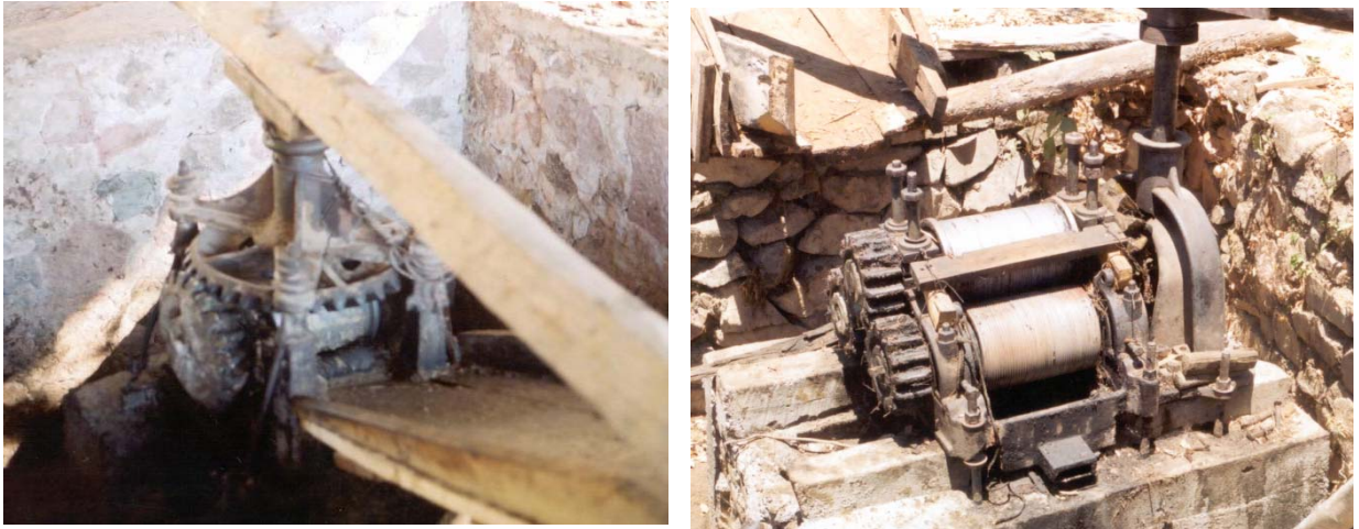
Figura 7. Molinos utilizados en Tamazula, Durango para la molienda de piñas de agave (Tomado de Valenzuela-Ruiz y col., 2003)
