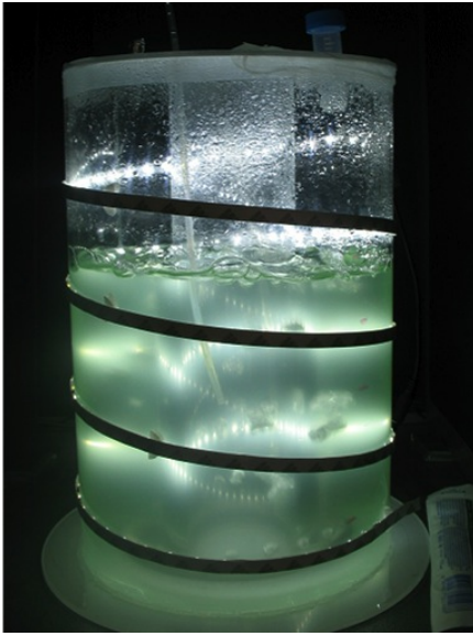
Figura 9. Fotobiorreactor con sistema lumínico de LEDS externo (FBR 2).
