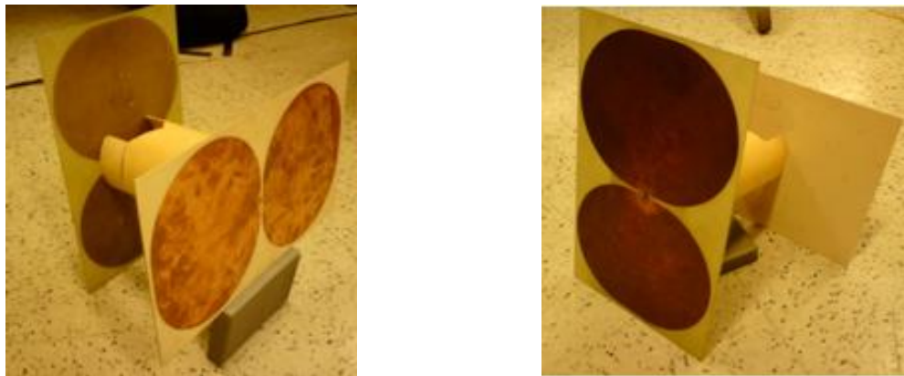
Figura. 4.10 Fotografías del arreglo ortogonal de antenas de banda ancha construido.
