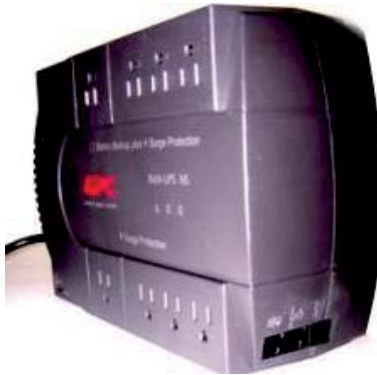
Figura 5.16.- UPS / No break.
