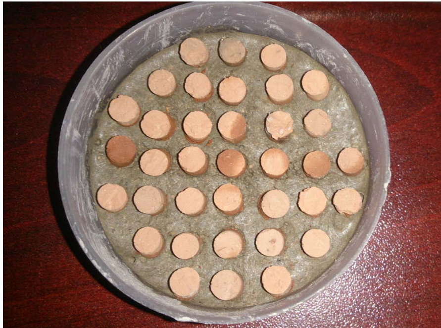
fig. 6.10 distribución de la arcilla en el mortero.
