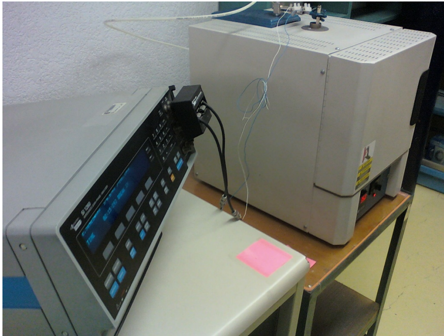
Fig 1. Montaje experimental para la impedancia eléctrica.
