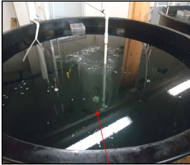
Fig.18. Fotografía de la fuente de aire central en el fondo del tanque en el laboratorio.
