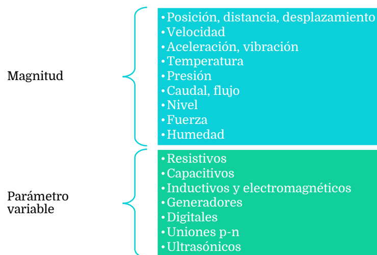
Figura 3. Clasificación de los sensores por magnitud y parámetro variable
