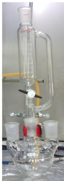
**Figura 2. 1 Sistema de adición. Se muestra el matraz adicionador y embudo de tres bocas.**
