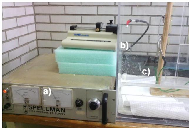
**Figura 2. 3 Se compone de un sistema de a) alta tensión, b) un hilador y c) un colector.**
