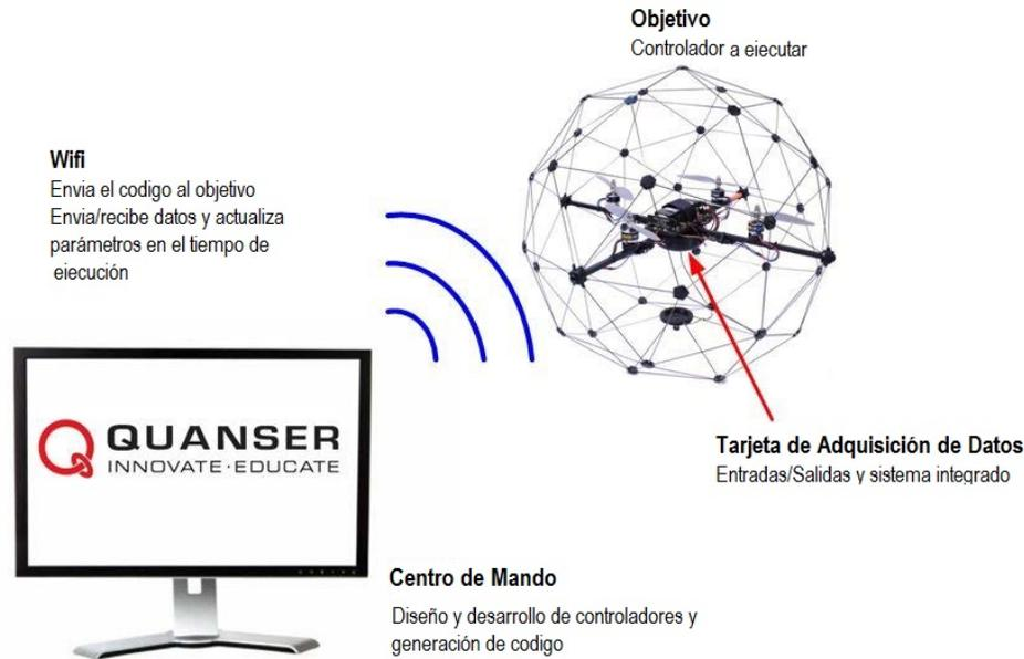
**Figura 2.5:** Diagrama del sistema.
