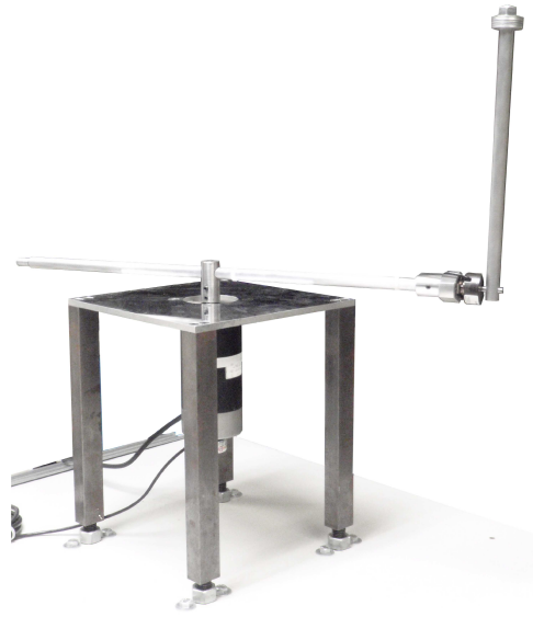
Figura 3.2: Fotografía del prototipo del péndulo de Furuta disponible en CITEDI-IPN.
