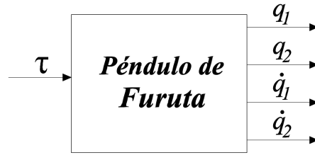
Figura 3.4: Representación esquemática o de bloques del péndulo de Furuta.
