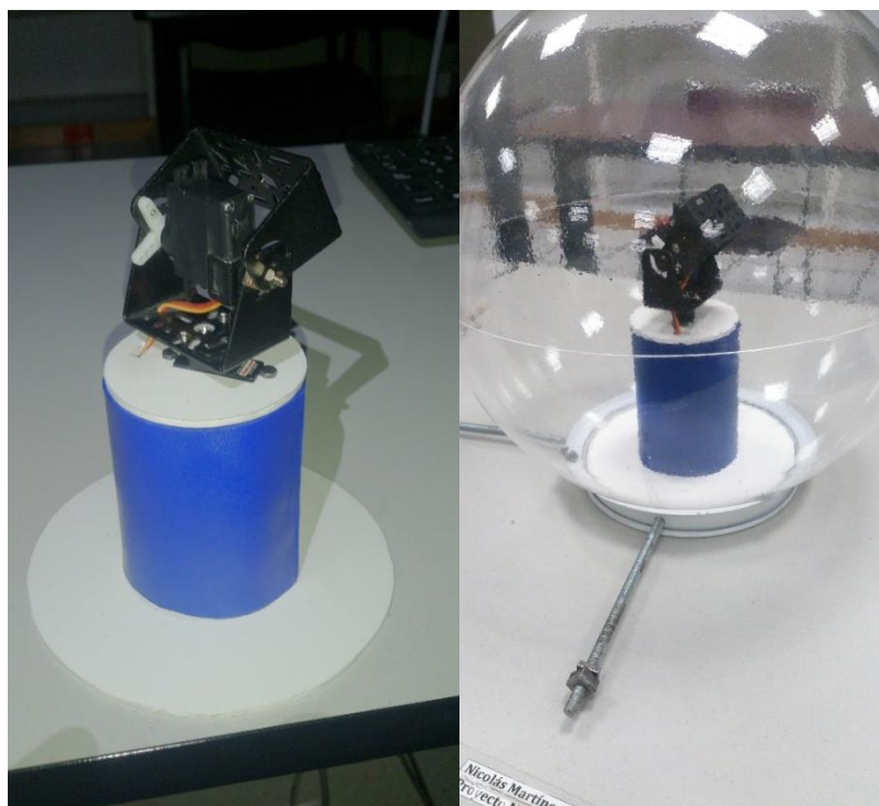
Ilustración 9. Montado de la estructura de los servomotores.
