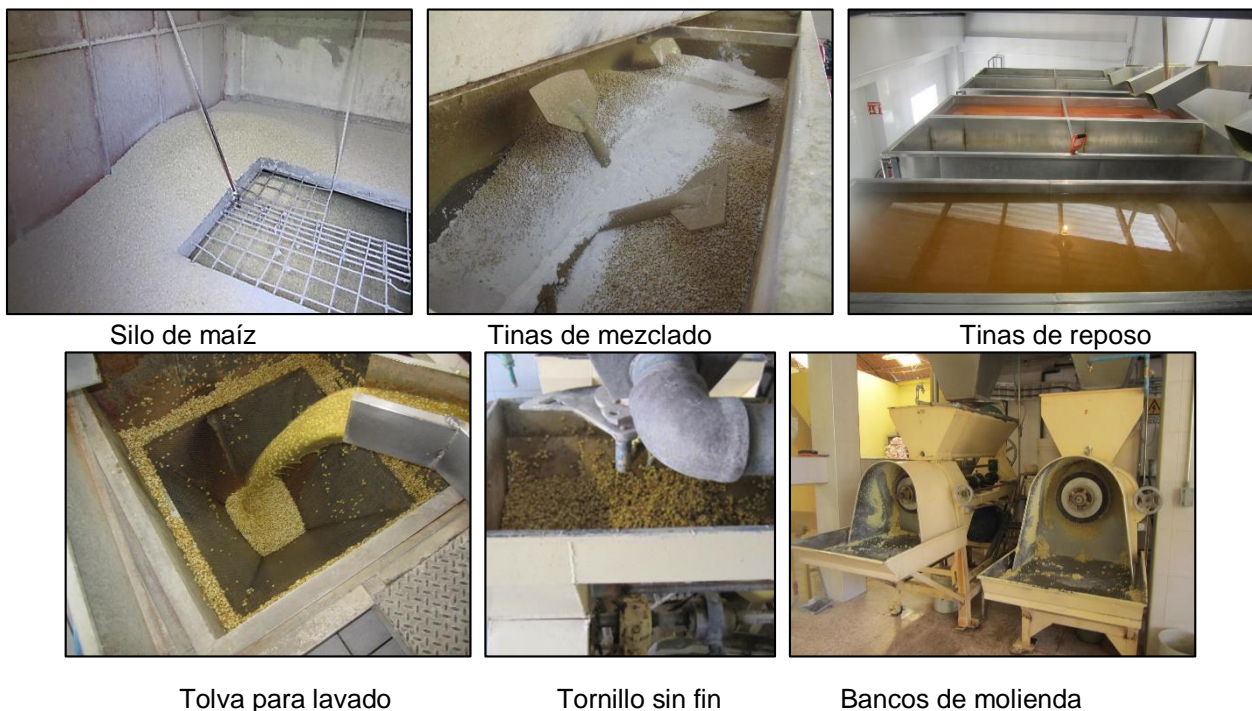
Figura 7. Fotografías del proceso de nixtamalización.
