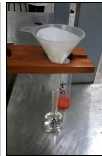
Filtración de digestiones
