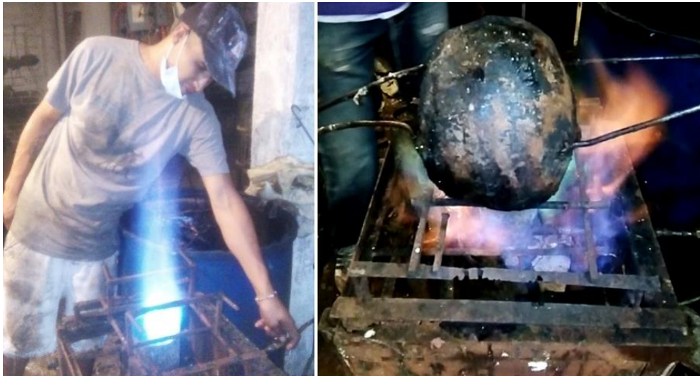
Figura 4.20 Molde vacío calentando cerca de la fuente de calor. Fuente: Vinisol.
