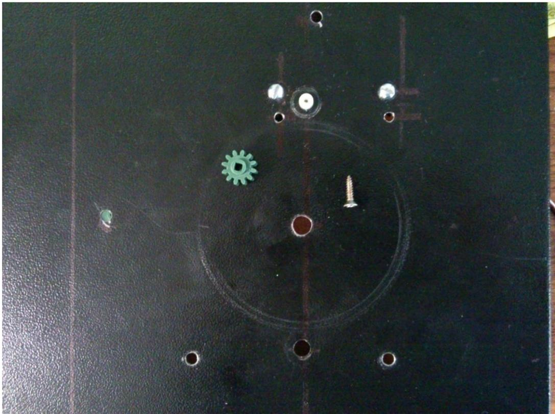
Figura 7.6 Base perforada y servomotor en posición.
