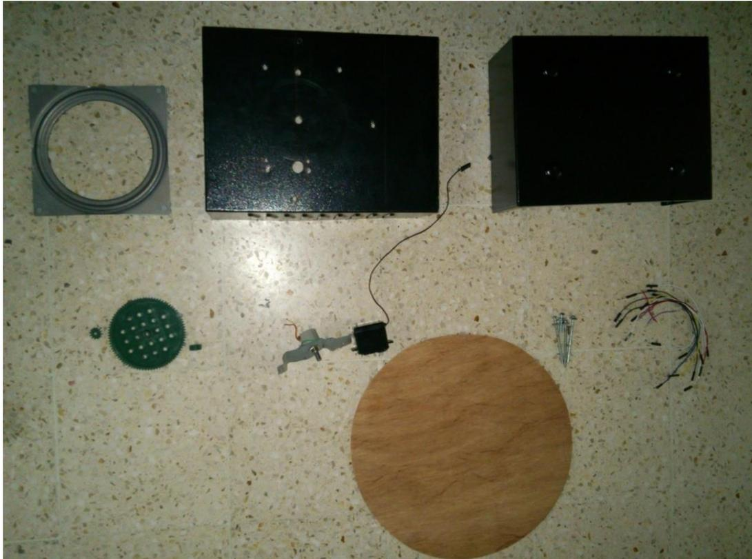
Figura 7.5 Componentes de base giratoria
