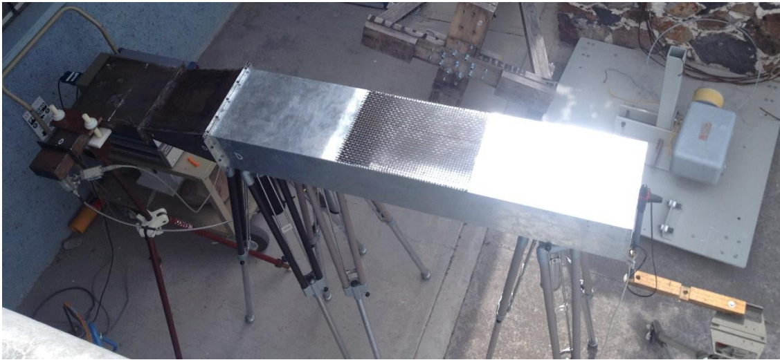
Figura 3. 22. Medición de distribución de campo en la apertura del ducto con rejilla.
