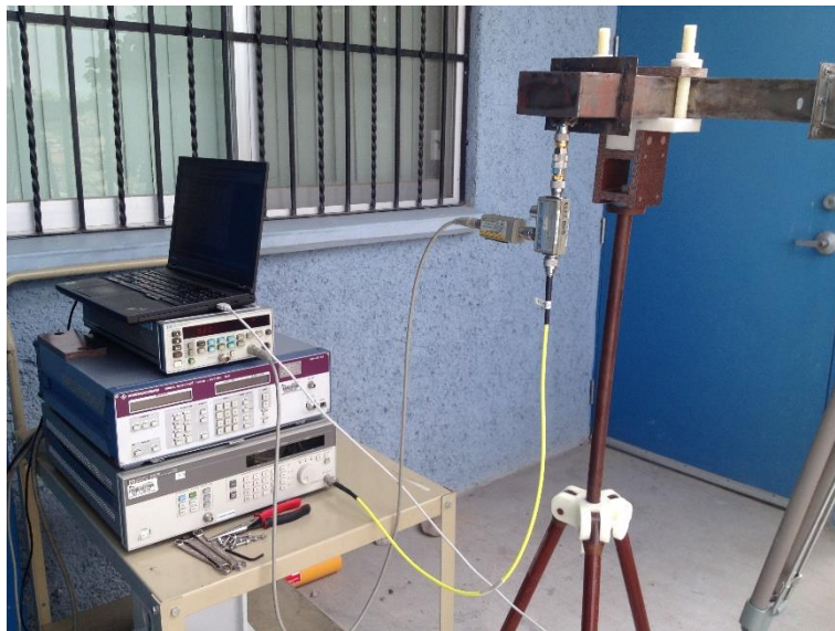
Figura 3. 12 Medición de distribución de campo en la apertura del convertidor.
