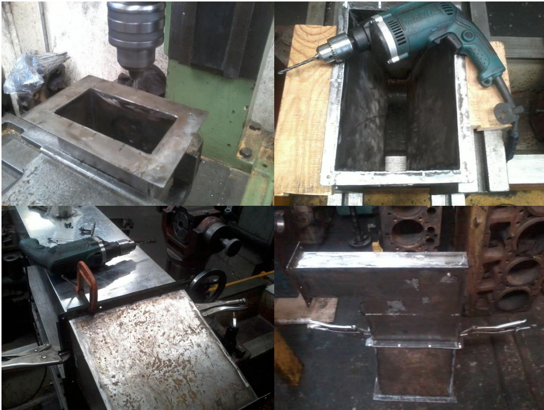
Figura A1. 19. Forma de barrenar las cejas de cada una de las estructuras.
