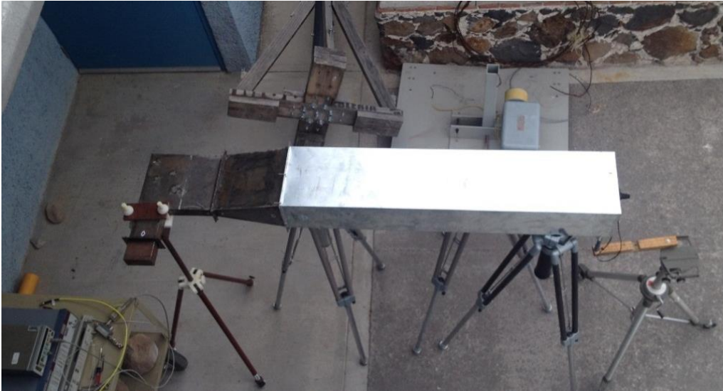
Figura 3. 19 Medición de distribución de campo en la apertura del ducto.
