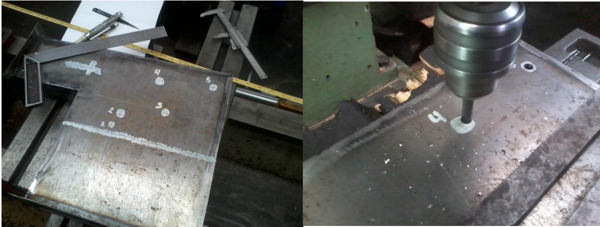
Figura A1. 11. Marcado de centros, montaje y barrenado de convertidor de campo eléctrico.
