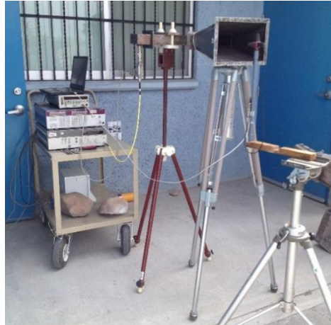
Figura 3. 15 Medición de distribución de campo en la apertura de corneta.
