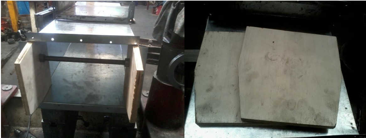
Figura A1. 20. Guías para hacer coincidir las estructuras antes de barrenar.
