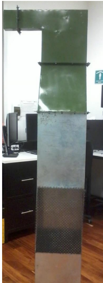
Figura 3. 21 Sistema de alimentación con ducto soldado a malla metálica.
