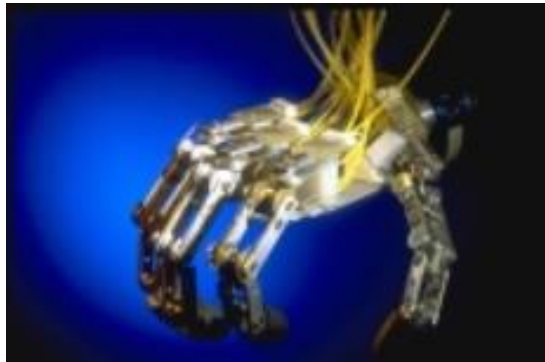
Figura I. 7 La mano DIST. Manipulador de alta destreza con 16 grados de libertad [14]
