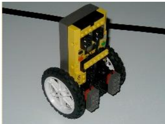
Figura I. 3 Sistema péndulo invertido sobre dos ruedas “Legway” [8]
