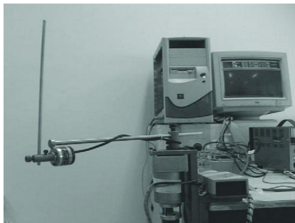
Figura I. 4 Diseño de un sistema péndulo invertido mediante algoritmos genéticos [9]
