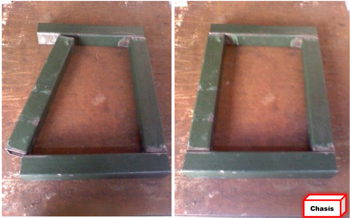
Figura V.1.- Base soldada del vehículo
