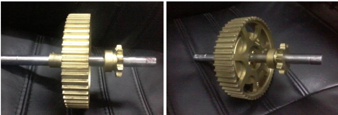
Figura V.8.- Esquema del ajuste realizado a las ruedas dentadas para su correcta fijación
