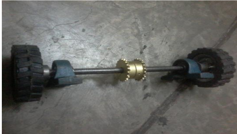
Figura V.22.- Eje que impulsa las llantas traseras del vehículo
