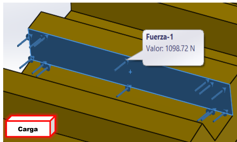
Figura IV.57.- Fuerza de 1098.72 N aplicada en el diente del engrane de distribución
