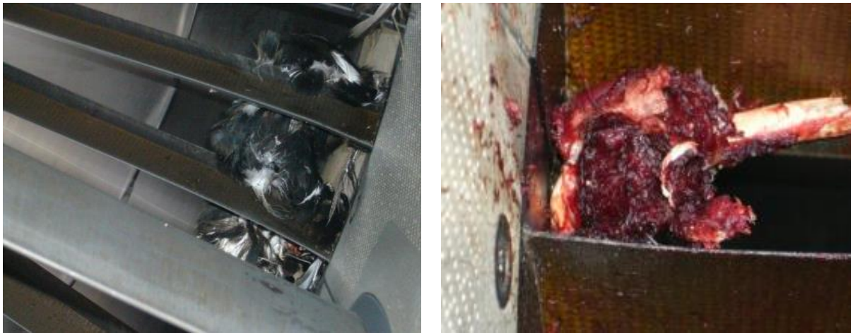
Figura I.22.- Ave succionada por el motor #1 y restos del ave atrapada
