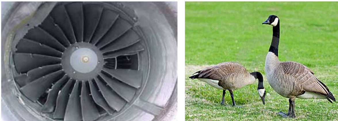
Figura I.15.- Motor #2 del Fokker-100 dañado al ingerir gansos canadienses
