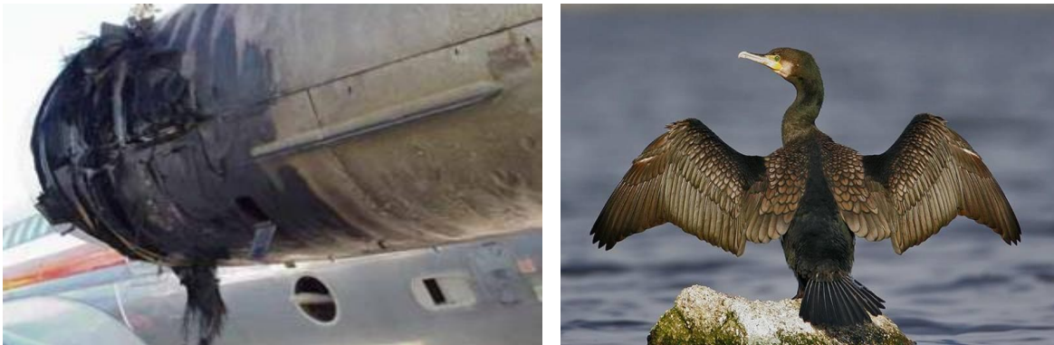
Figura I.18.- Motor #1 del avión McDonnell Douglas DC-9-82 quemado después de succionar más de un cormorán
