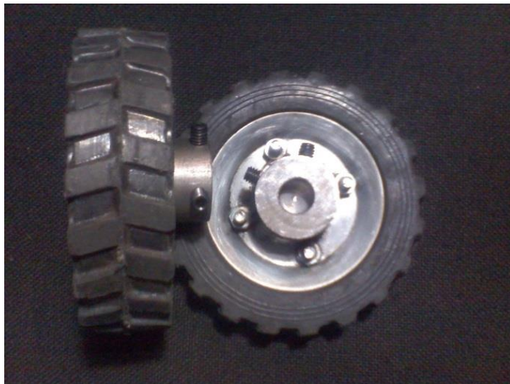
Figura V.17.- Bases de acero soldadas al rin de las llantas
