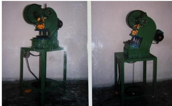
Fig. 2.18 Prensa tipo C cortesía Técnicos Campos.
