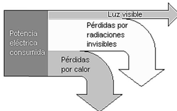
**Figura 8** - Transformación de la potencia eléctrica (consumo) en una lámpara incandescente.
