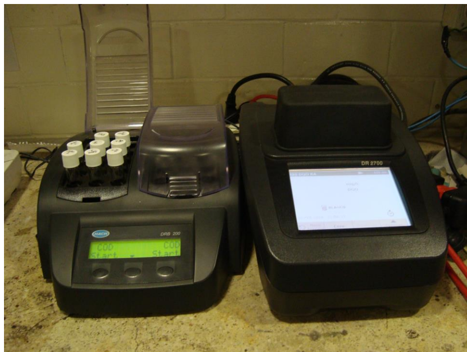
Figura 71 Equipo utilizado para la medición de la Demanda Química de Oxígeno Termo-reactor (marca: Hach);
