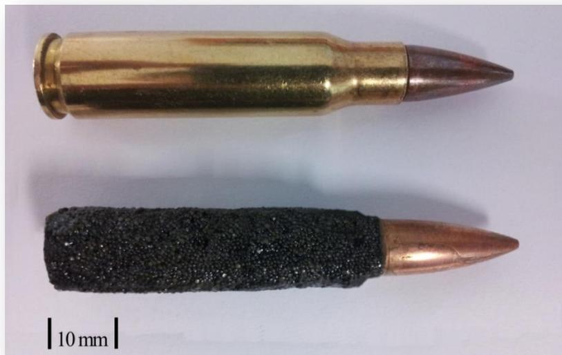
**Figura V.12.-** Munición Cal 7.62 x 51 mm FMJ y munición prototipo
