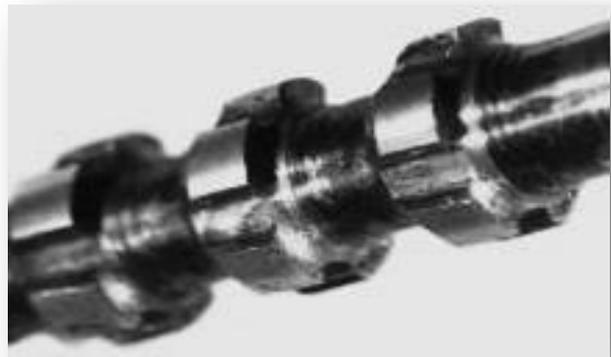
**Figura II.9.-** Brocha para estriado de cañones de armamento.
