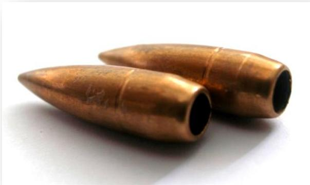
**Figura V.10.-** Prototipo fabricado de la ojiva calibre 7.62 mm sin núcleo.
