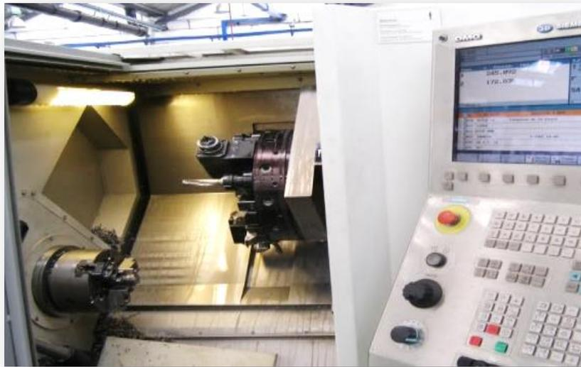
**Figura V.15.-** Centro de torneado de control numérico por computadora.
