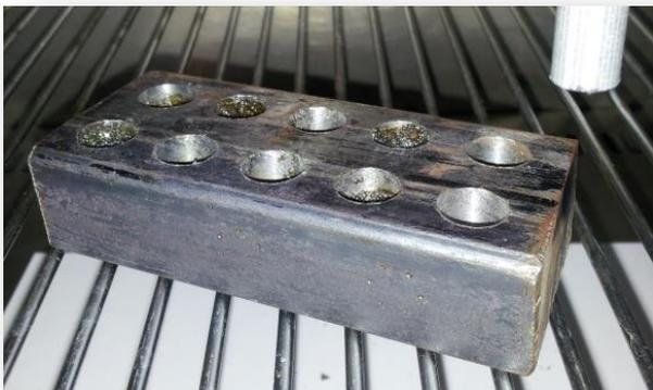
**Figura V.3.-** Molde para cilindros de pólvora.
