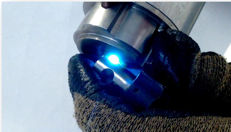
**Figura III.15.-** Espectrofotómetro de chispa empleado en el análisis químico cualitativo.
