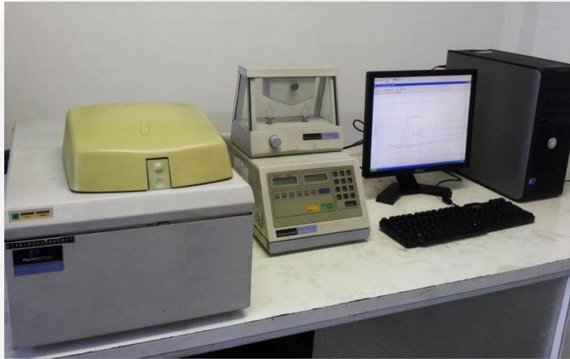
**Figura V.25.-** Calorímetro Diferencial de Barrido marca Perkin Elmer, modelo Pyris Diamond.
