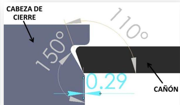
**Figura III.35.-** Interferencia de ángulo mínimo de la cabeza con ángulo máximo del cañón.
