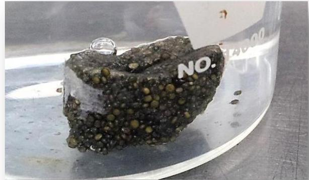
**Figura V.22.-** Prueba de solubilidad de un cilindro de 1 g. de pólvora aglutinada.
