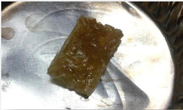
**Figura V.17.-** Película de goma arábica de 1 mm de espesor.
