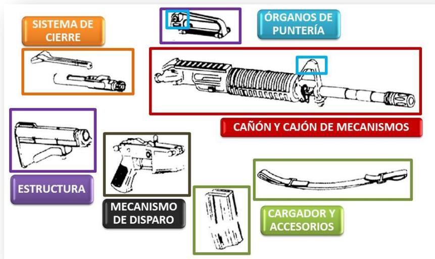
**Figura I.3.-** Identificación de los principales componentes de un fusil M4 A1 [*M4A1 Technical manual, 1997*].
