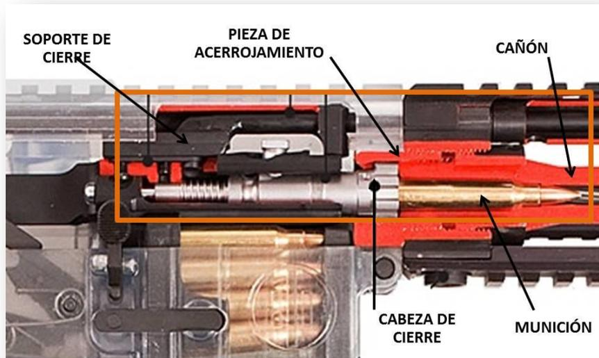
**Figura III.4.-** Acercamiento al sistema de cierre de un fusil MK 109, calibre 300 AAC Blackout [MK 109 cutaway view, 2012].
