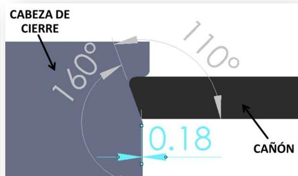
**Figura III.33.-** Interferencia de cualquier combinación de los ángulos que sume 270°.
