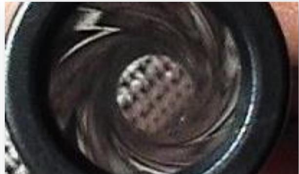
**Figura II.5.-** Estriado poligonal de un cañón de pistola HK USP calibre 9 x 19 mm, de fabricación alemana.
