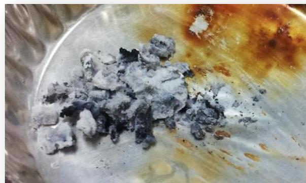
**Figura V.20.-** Incombustos generados por una película de goma arábica.
