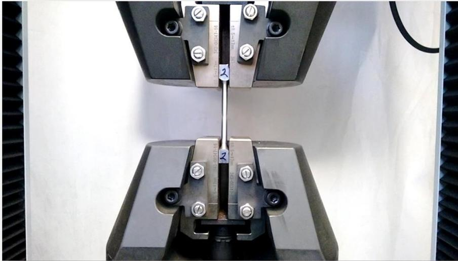
**Figura III.38.-** Máquina de tensión y compresión empleada en las pruebas elásticas.
