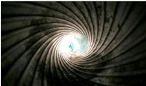
**Figura II.4.-** Estriado de un cañón de calibre 75 mm, de manufactura francesa.
