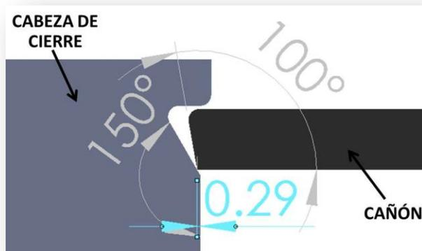
**Figura III.34.-** Interferencia de ángulo mínimo de la cabeza con ángulo mínimo del cañón.
