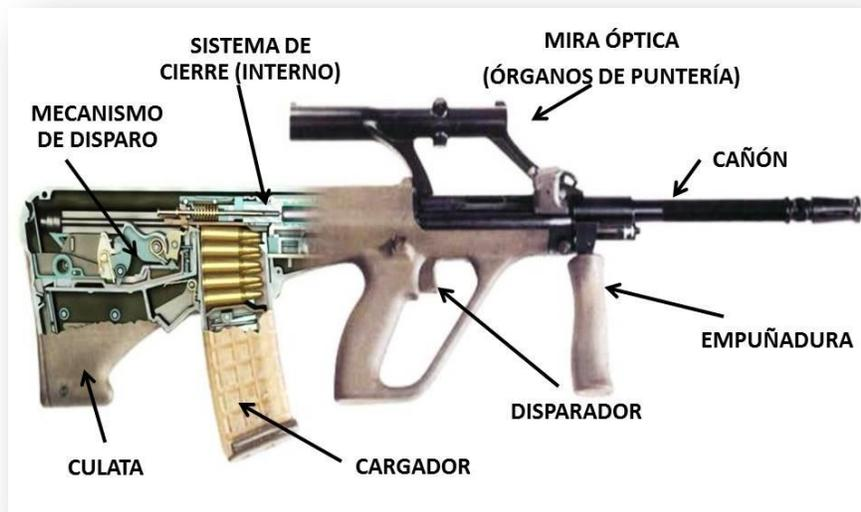
**Figura I.4.-** Esquema del interior de un fusil Steyr AUG, calibre 5.56 x 45 mm tipo *bullpup* [Steyr AUG cutaway view, 2012].
