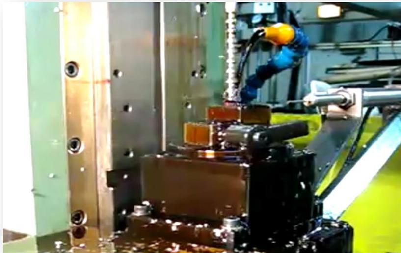
**Figura V.13.-** Máquina típica de brochado vertical para la fabricación del estriado de cañones.
