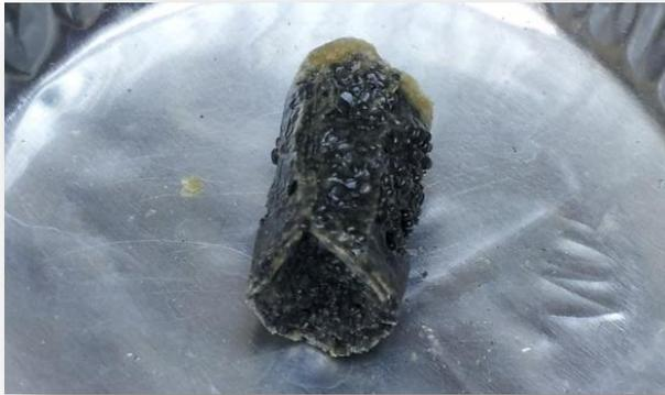
**Figura V.21.-** Cilindro de 1 g de pólvora aglutinada con goma arábica.
