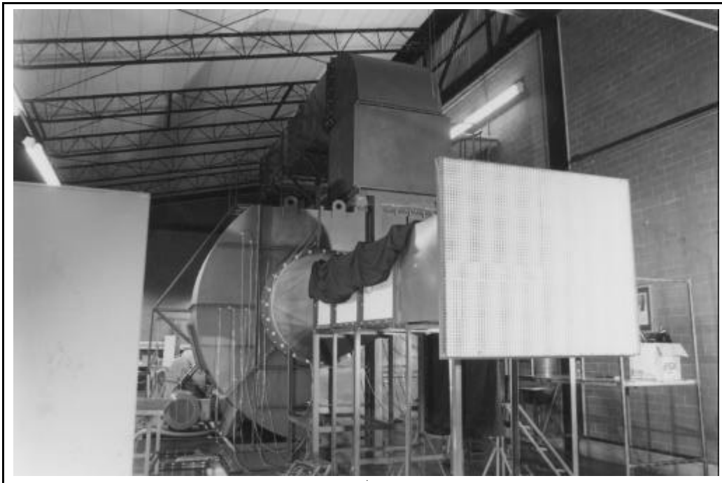
Figura 3.1 Túnel de viento de velocidad baja del LABINTHAP.
