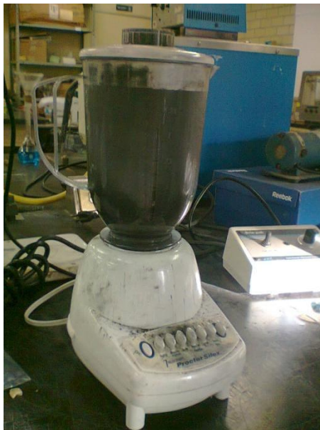
Figura 11. Atricionador moliendo baterías de celular
