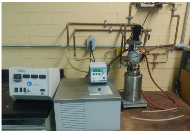
Figura 2.3 Reactor intermitente utilizado en la evaluación de catalizadores NiMo/Al 2 O 3 .
