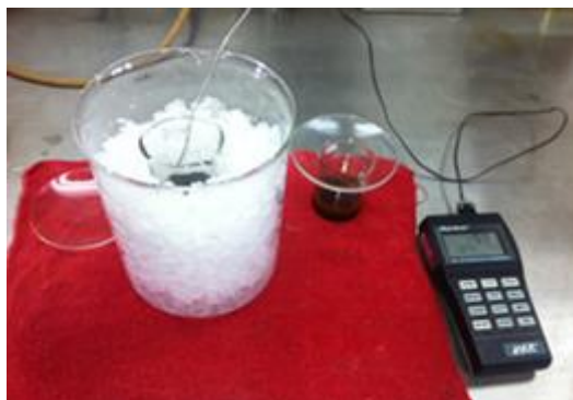
Figura 1.10 Equipo para determinar la masa molecular de una mezcla de hidrocarburos.
