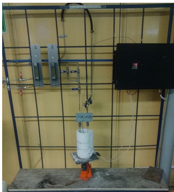
Figura 2.2 Reactor de vidrio en U para la activación de materiales catalíticos.
