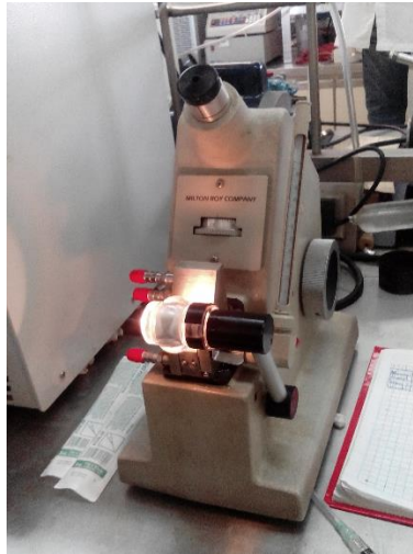
Figura 1.11 Refractómetro utilizado para determinar el Índice de refracción de hidrocarburos.
