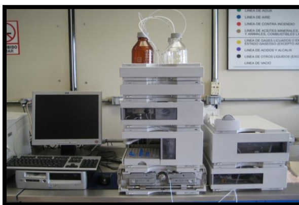
Figura 2.10 Fotografía del equipo de Cromatografía por Exclusión de Tamaños del laboratorio del Instituto Mexicano del Petróleo (I.M.P.)
