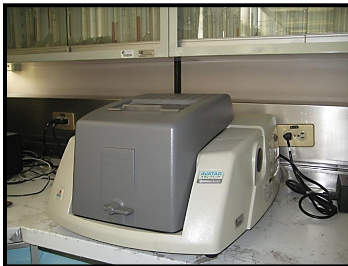
Figura 2.5 Equipo de FTIR utilizado en la elucidación estructural de las muestras analizadas del I.M.P.
