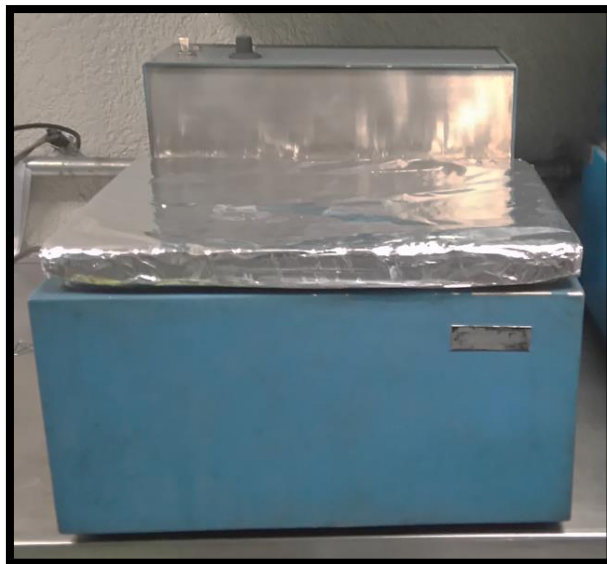
Figura 2.1 Baño térmico utilizado para las evaluaciones fisicoquímicas de los nuevos agentes deshidratantes.
