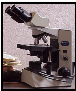
Figura 2.12 Microscopio óptico utilizado para la caracterización de las emulsiones de agua-en-aceite crudo.
