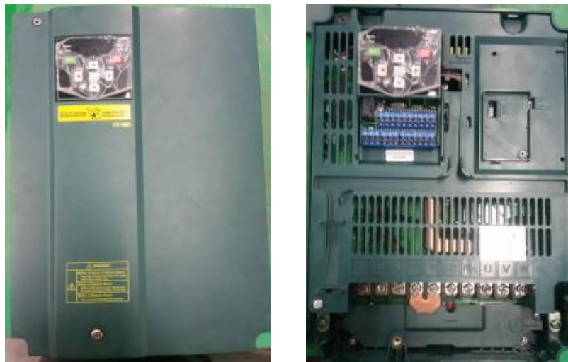
Fig.3.10 Drive del primo motor del sistema de generación de laboratorio.
