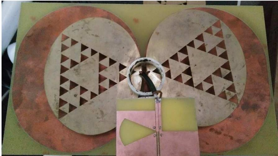
Fig. 5.11 Comparación de la antena dipolo de brazos elípticos con técnica fractal en comparación con la antena original.
