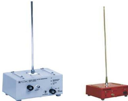
Fig. 1.5 Antenas tipo monopolo comerciales.
