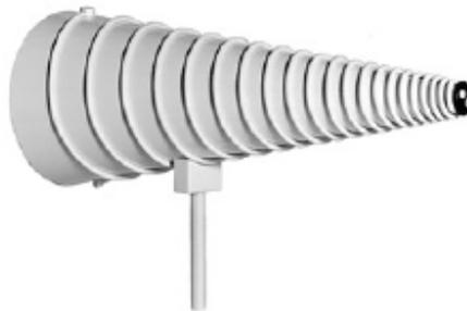
Fig. 1.10 Antena espiral cónica logarítmica.
