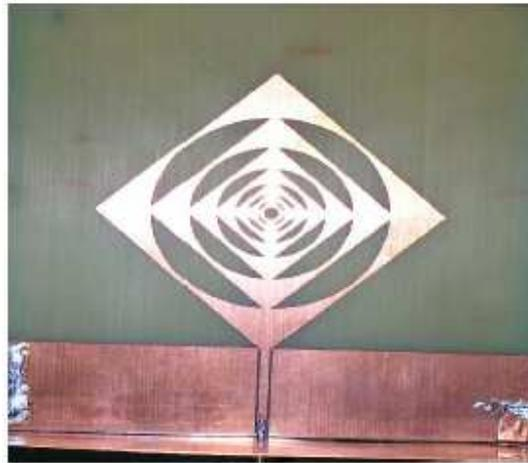
Fig. 2.20 Antena monopolo cuadrado de ultra ancho de banda [26].
