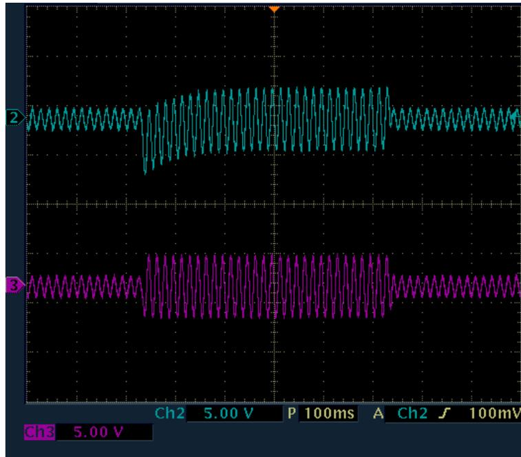
**Figura B.13.** Falla aplicada con componente decreciente de CD (canal 2 del osciloscopio), y misma señal de corriente a la salida del filtro *mimic* (canal 3 del osciloscopio).
