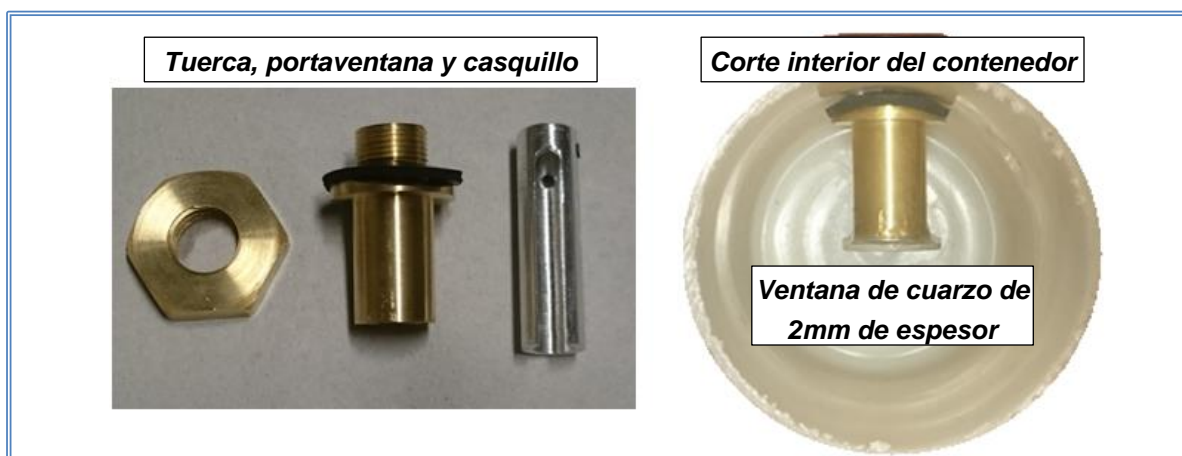
Figura 2-15 Diseño y montaje del portaventana de cuarzo
