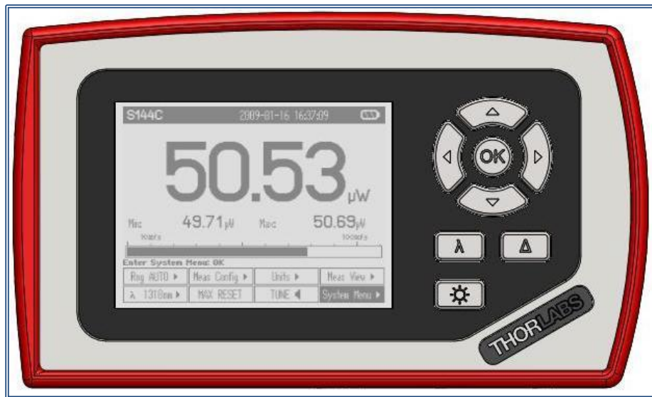
Figura 2-10 Vista frontal del medidor
