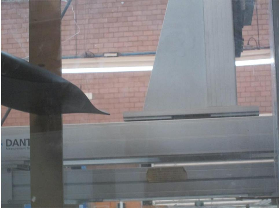
Figura 3.47. Sonda de hilo caliente de una dimensión 55P15, realizando el en el borde de salida, a una velocidad de 25m/s, nivel de turbulencia de 0.5 % y un ángulo de ataque  $\alpha=0^\circ$ .
