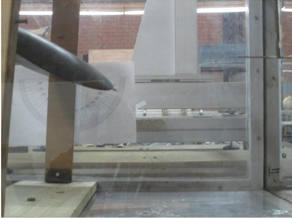
Figura 3.43. Sonda de hilo caliente de una dimensión 55P15, realizando el barrido en el borde de salida, a una velocidad de 15m/s, nivel de turbulencia de 0.5 % y un ángulo de ataque  $\alpha=15^\circ$  .
