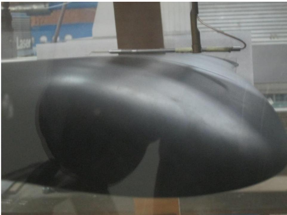
Figura 3.36. Sonda de hilo caliente de una dimensión 55P15, realizando el barrido en el borde de ataque, a una velocidad de 15m/s, nivel de turbulencia de 0.5 % y un ángulo de ataque  $\alpha=0^\circ$ .
