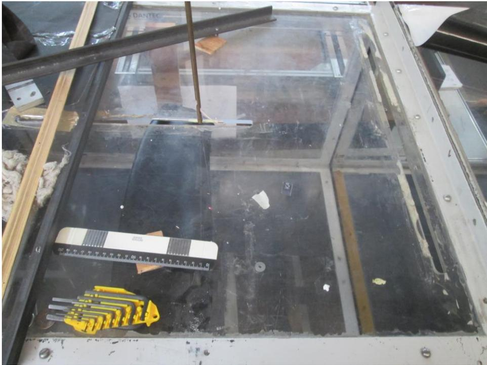
Figura 3.44. Sonda de hilo caliente de una dimensión 55P15, realizando en el borde de ataque, a una velocidad de 25m/s, nivel de turbulencia de 0.5 % y un ángulo de ataque  $\alpha=0^\circ$ .
