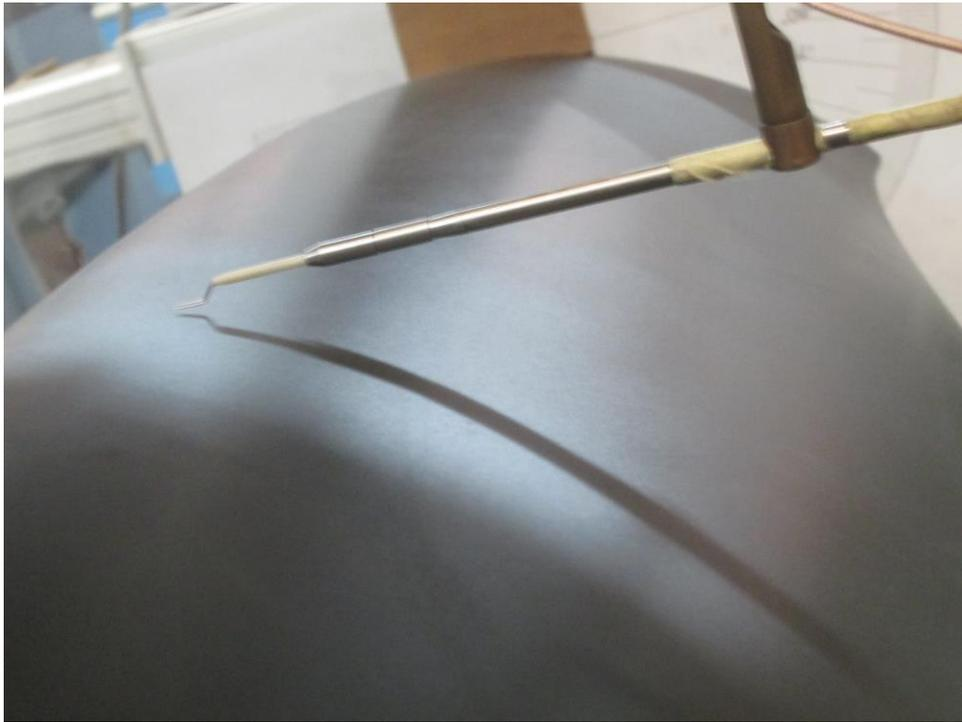
Figura 3.41. Sonda de hilo caliente de una dimensión 55P15, realizando el barrido a 7 centímetros de distancia del borde de ataque, a una velocidad de 15m/s, nivel de turbulencia de 0.5 % y un ángulo de ataque  $\alpha=15^\circ$ .
