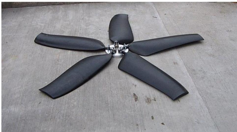
Figura 3.18. Hélice de diámetro de 1.6m., con alabes hechos de fibra de vidrio.
