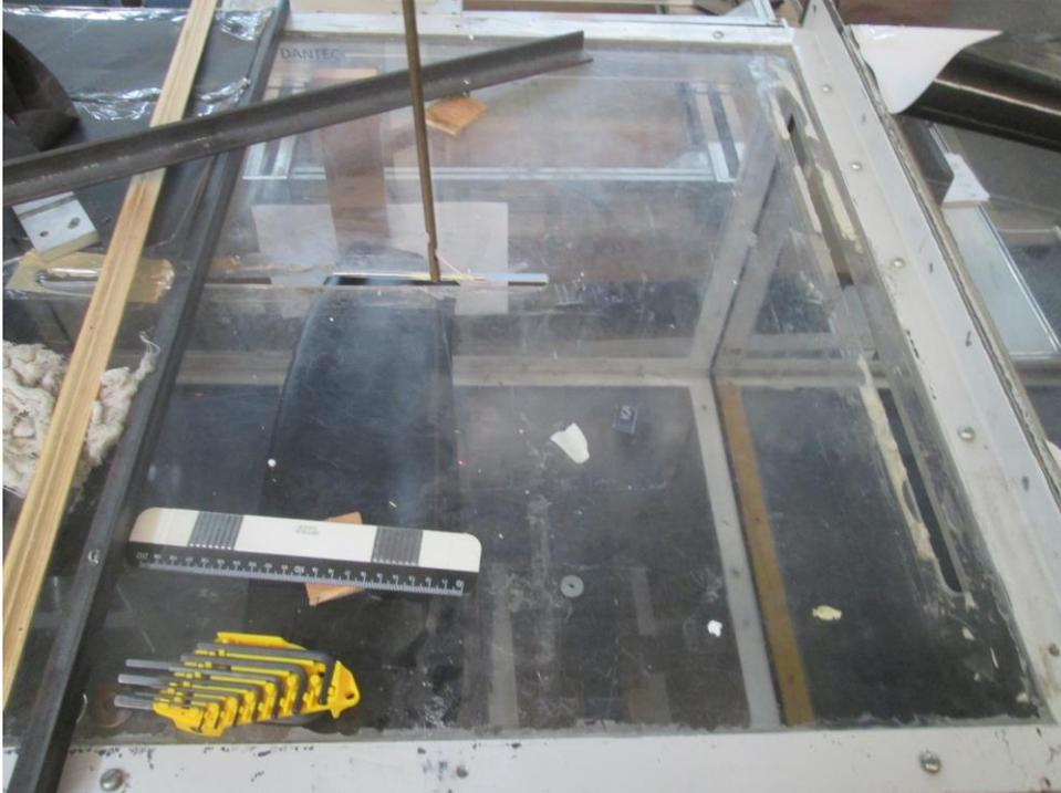
Figura 3.37. Sonda de hilo caliente de una dimensión 55P15, realizando el barrido a 7 centímetros de distancia del borde de ataque, a una velocidad de 15m/s, nivel de turbulencia de 0.5 % y un ángulo de ataque  $\alpha=0^\circ$ .
