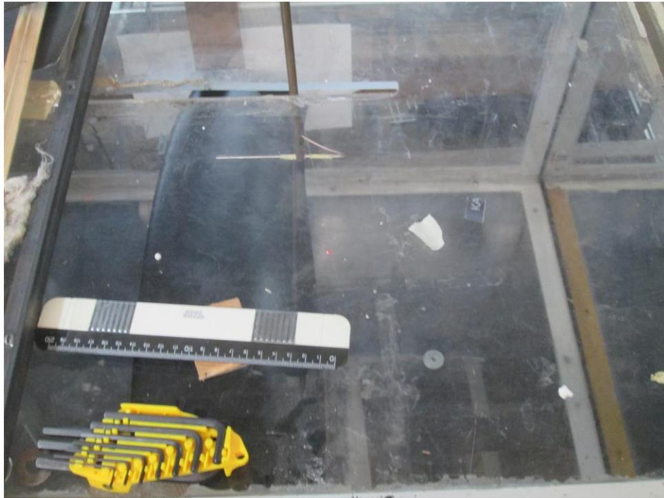
Figura 3.45. Sonda de hilo caliente de una dimensión 55P15, realizando el barrido a 7 centímetros de distancia del borde de ataque, a una velocidad de 25m/s, nivel de turbulencia de 0.5 % y un ángulo de ataque  $\alpha=0^\circ$ .
