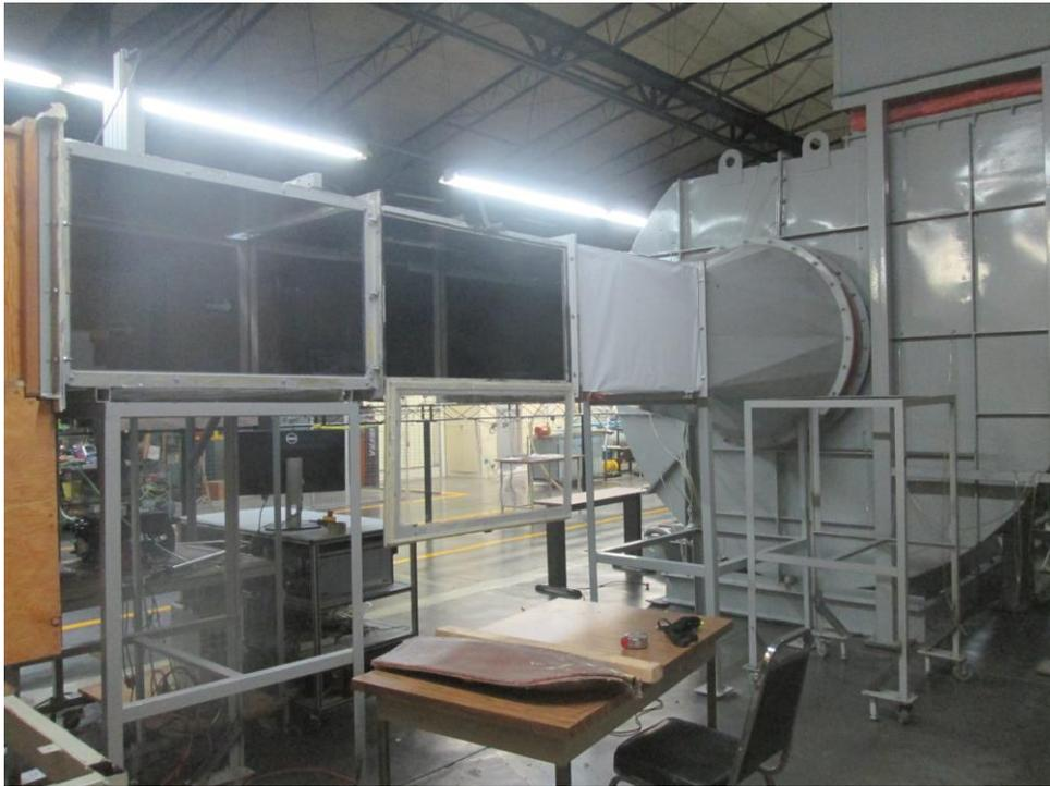
Figura 3.27. Túnel de viento del LABINTHAP.
