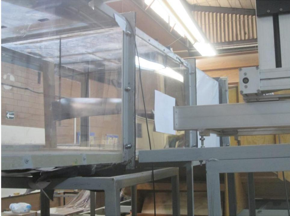
Figura 3.39. Sonda de hilo caliente de una dimensión 55P15, realizando el barrido en el borde de salida, a una velocidad de 15m/s, nivel de turbulencia de 0.5 % y un ángulo de ataque  $\alpha=0^\circ$ .
