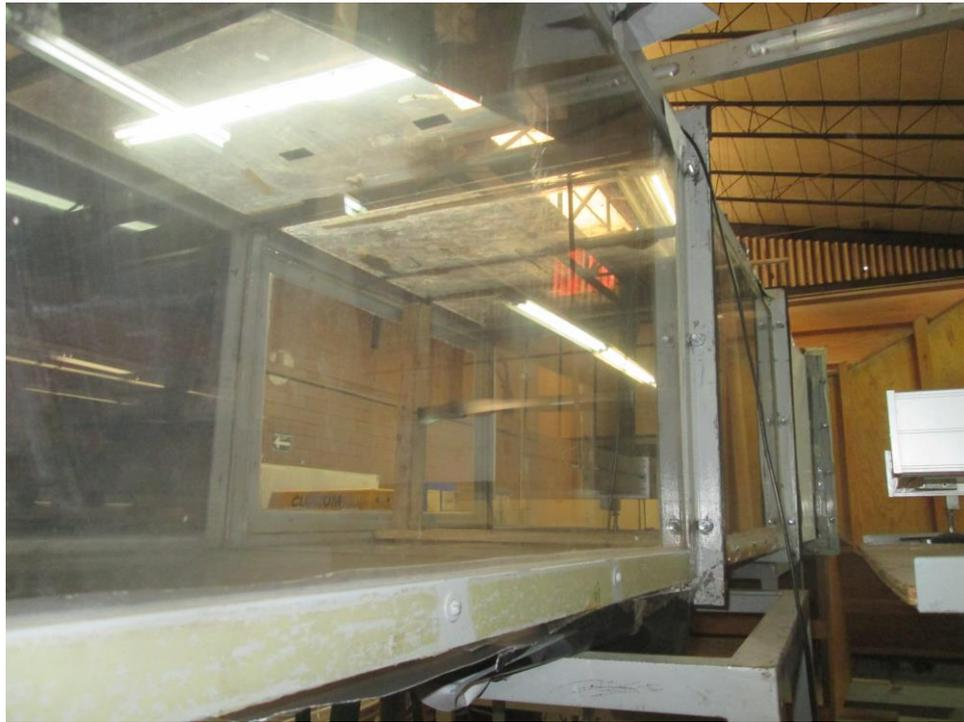
Figura 3.46. Sonda de hilo caliente de una dimensión 55P15, realizando el barrido a 12 centímetros de distancia del borde de ataque, a una velocidad de 25m/s, nivel de turbulencia de 0.5 % y un ángulo de ataque  $\alpha=0^\circ$ .
