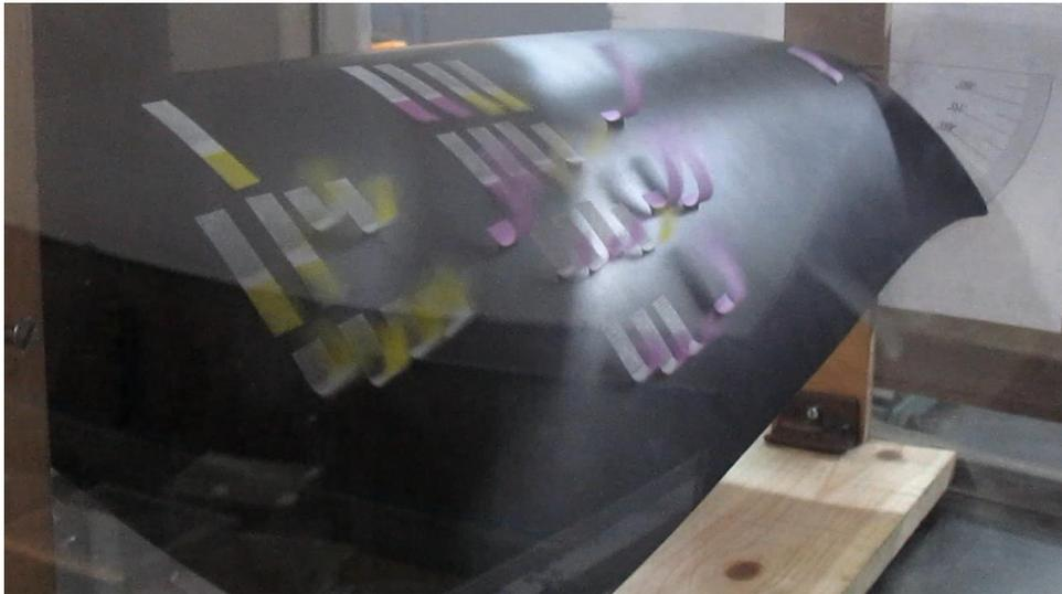
Figura 3.51. Visualización de separación de flujo a un ángulo de ataque  $\alpha=42^\circ$ .
