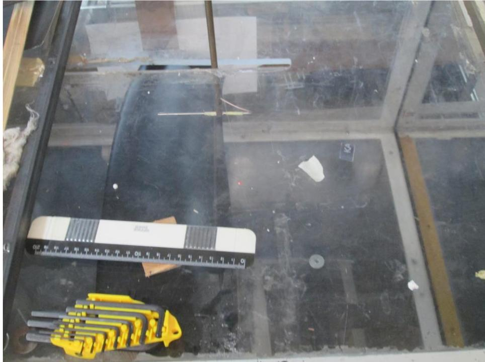
Figura 3.38. Sonda de hilo caliente de una dimensión 55P15, realizando el barrido a 12 centímetros de distancia del borde de ataque, a una velocidad de 15m/s, nivel de turbulencia de 0.5 % y un ángulo de ataque  $\alpha=0^\circ$ .
