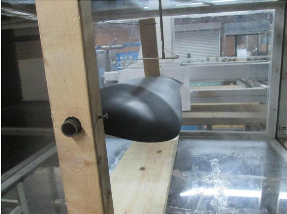
Figura 3.40. Sonda de hilo caliente de una dimensión 55P15, realizando el barrido en el borde de ataque, a una velocidad de 15m/s, nivel de turbulencia de 0.5 % y un ángulo de ataque  $\alpha=15^\circ$ .
