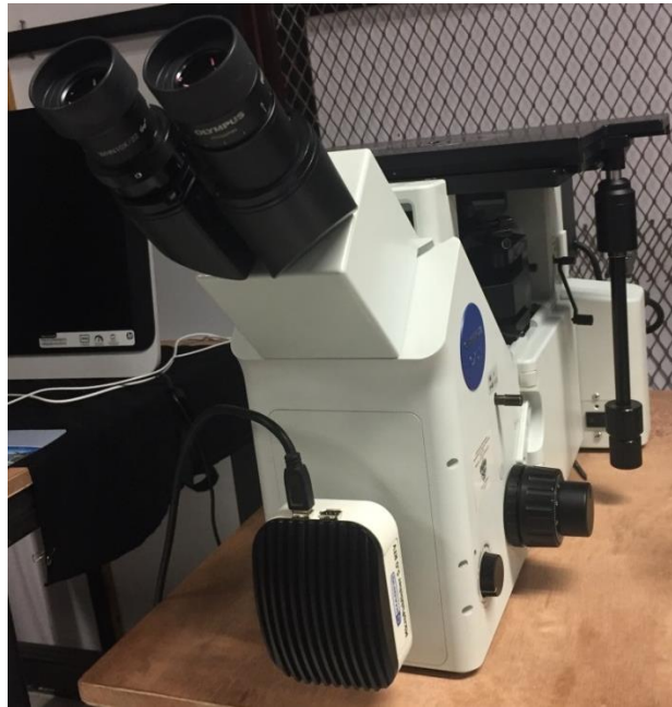
Figura 3.3. Microscopio óptico Olympus GX51, equipo perteneciente al Grupo Ingeniería de Superficies, GIS ® , del IPN
