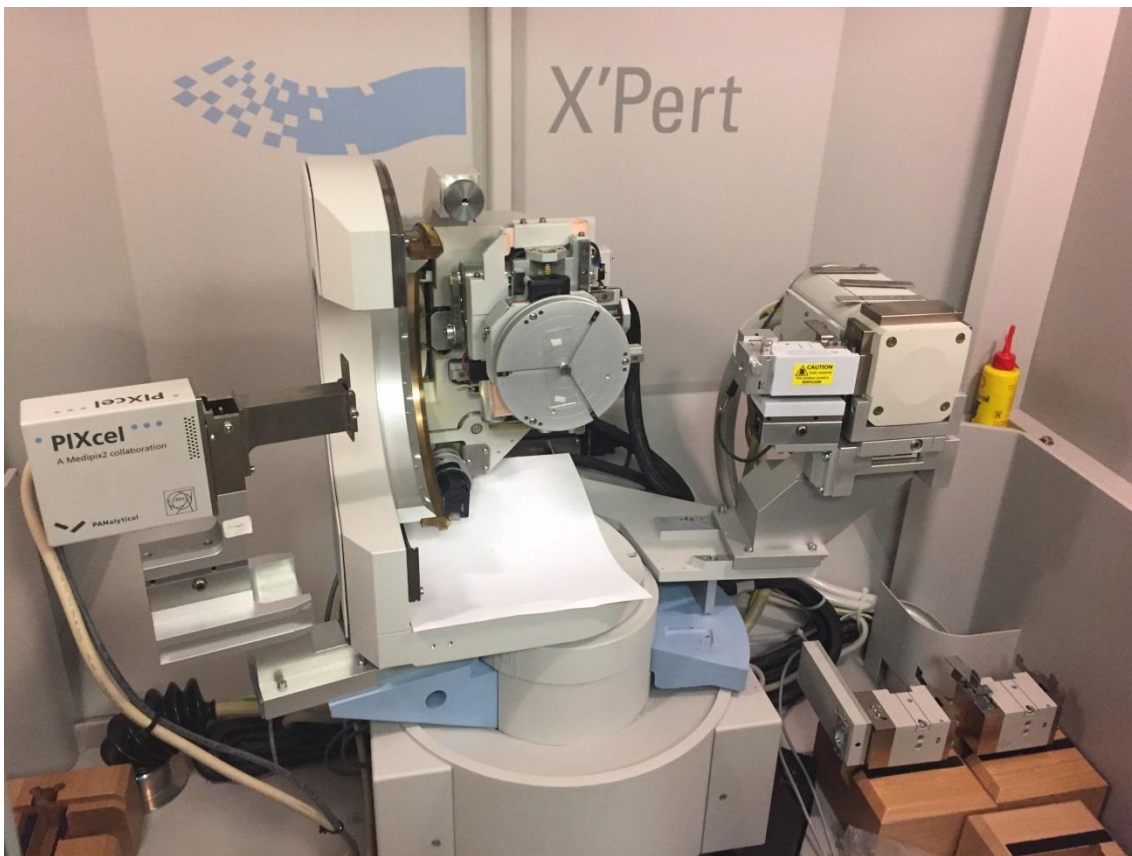
Figura 3.6. Difractómetro de rayos X X'Pert PRO PANalytical, equipo perteneciente al Centro de Nanociencias y Micro y Nanotecnologías del IPN
