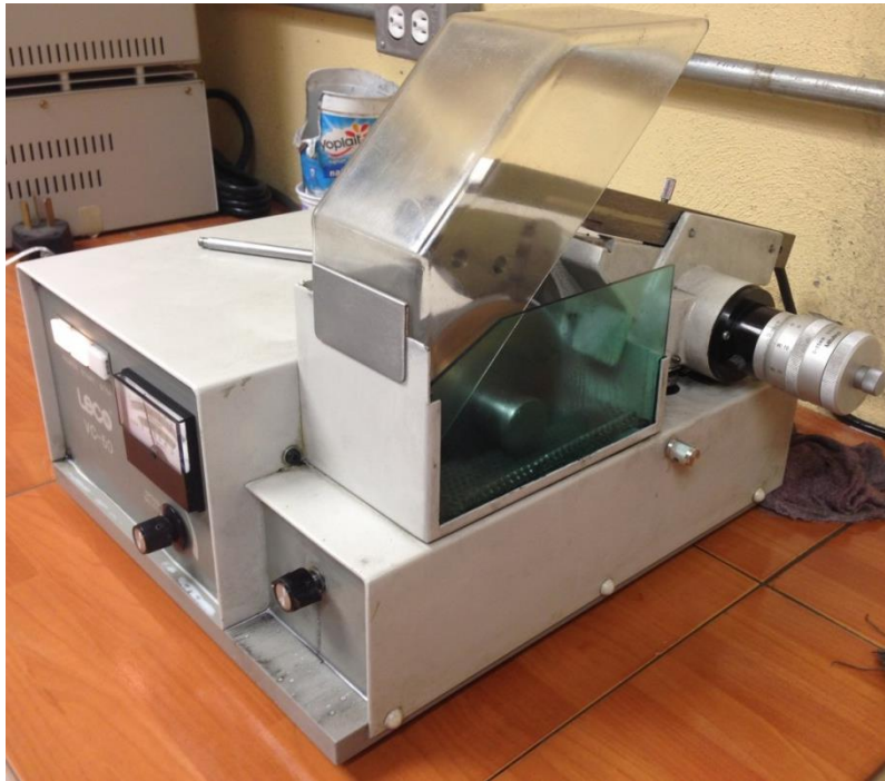
Figura 3.1 Cortadora de precisión Leco VC-50, equipo perteneciente al Grupo Ingeniería de Superficies, GIS ® , del IPN
