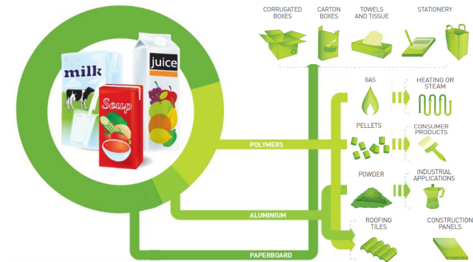
Figura 7. Diversificación de usos de los materiales obtenidos del reciclaje de los envases multicapa.
