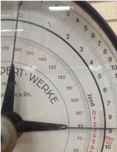
Figura 5. 19. Ángulo de acenso de la probeta tres, 79^\circ
