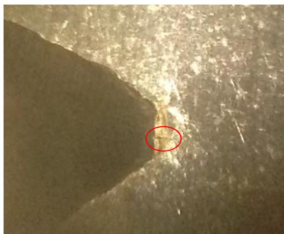
Figura 5.1. Inicio de la grieta por fatiga.
