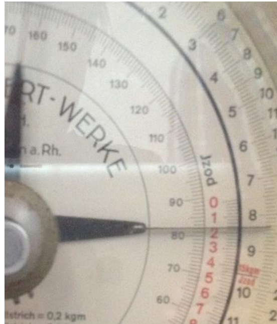
Figura 5. 18. Ángulo de acenso de la probeta dos, 82°
