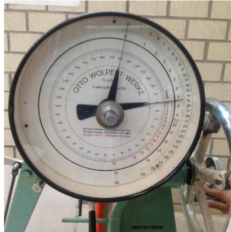
Figura 4.11. Obtención del ángulo de ascenso.
