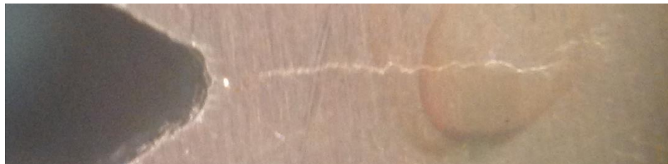
Figura 5. 4. Grieta de 2.5mm de la probeta dos.
