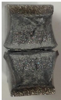
Figura 5. 31. Probeta 1 totalmente fracturada.
