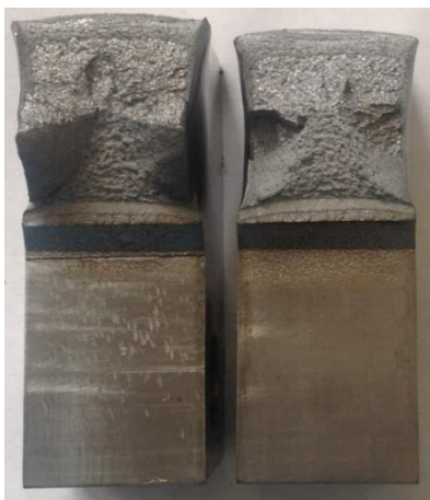
Figura 5. 8. Superficies de fractura probeta número uno.
