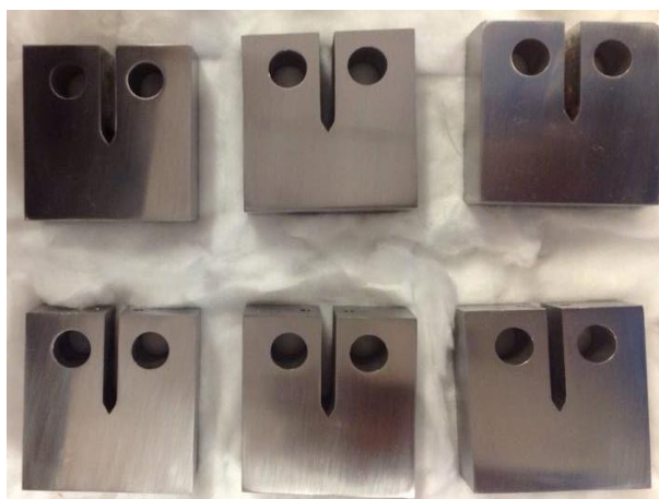
Figura 3.20. Probetas C (T) pulidas.
