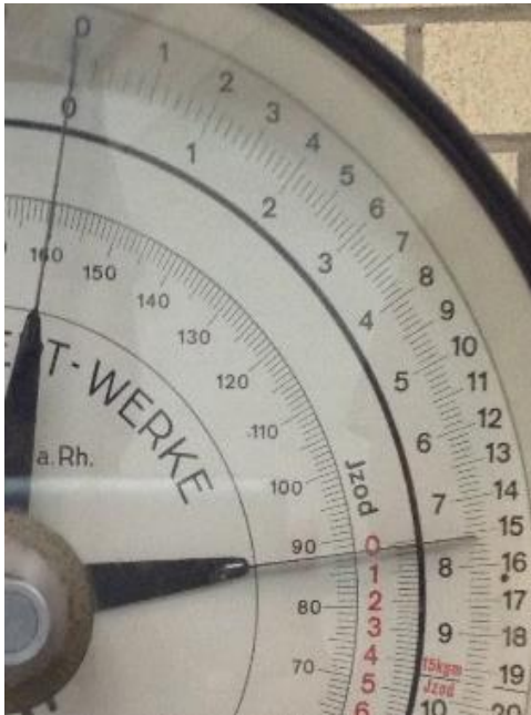
Figura 5. 17. Ángulo de acenso de la probeta uno, 88°
