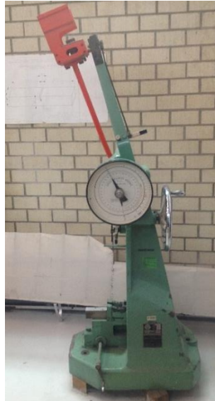
Figura 4.6. Péndulo para pruebas de impacto Charpy.
