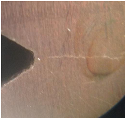
Figura 5. 3. Grieta por fatiga probeta dos.
