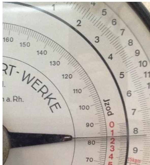
Figura 5. 22. Ángulo de acenso de la probeta siete, 83^\circ
