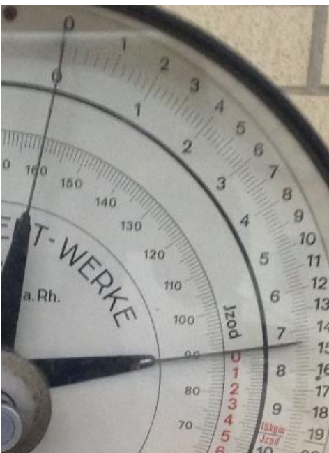
Figura 5. 21. Ángulo de acenso de la probeta seis, 90^\circ
