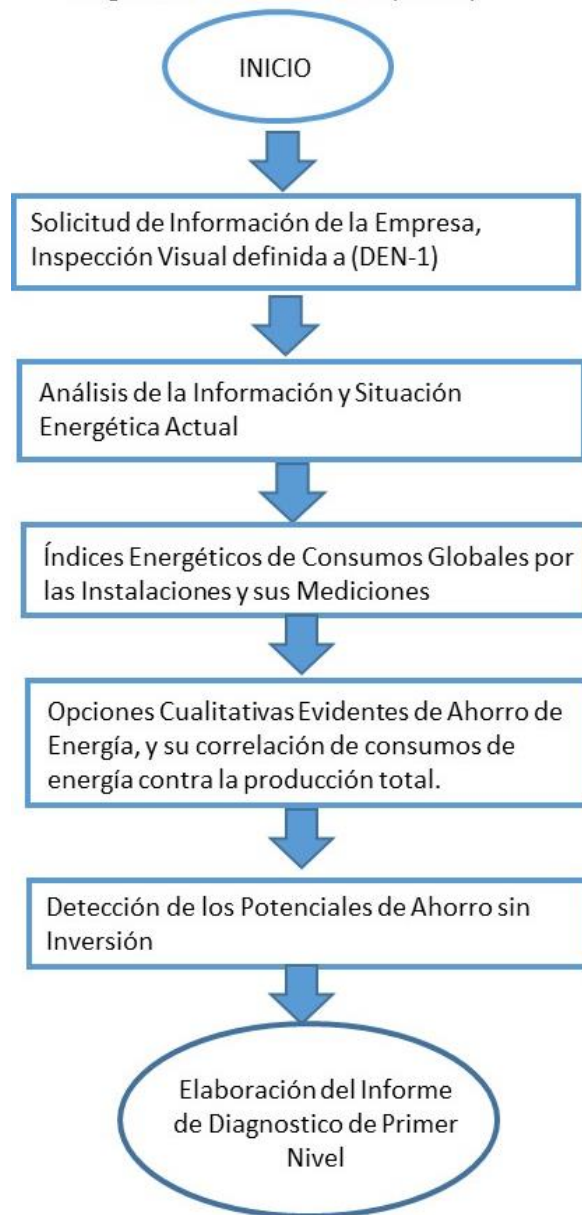
Figura 3.2 Diagrama de Primer Nivel Energético Fuente: Elaboración Propia
