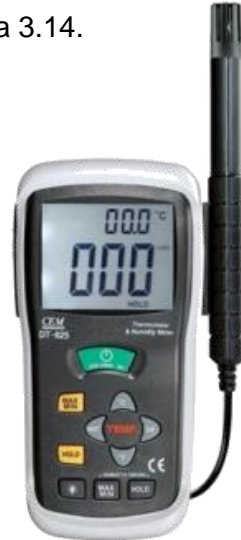
Figura 3.14 Ejemplo de termo higrómetro Fuente: Catalogo de Empresa J.S Industrial.
