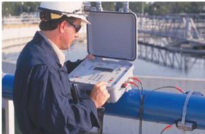
Figura 3.13 Ejemplo de medidor de flujo ultrasónico Fuente: Catalogo de Empresa J.S Industrial.
