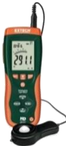
Figura 3.11 Ejemplo de luxómetro Fuente: Catalogo de Empresa Fluke.
