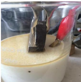
Figura 26 Toma de potencial electroquímico para el acero SAE 1018/CW-TiN
