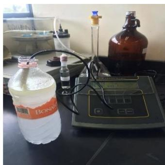
Figura 27 Medición de conductividad en aceite de Jatropha Curcas
