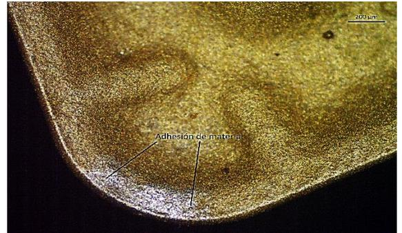
Figura 72 Microscopia óptica inserto v.s. aluminio 6061-T6 a 50x Jatropha Curcas
