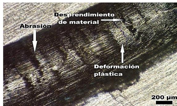
Figura 42 Microscopia óptica aluminio 6061-T6 a 50x en condición seca
