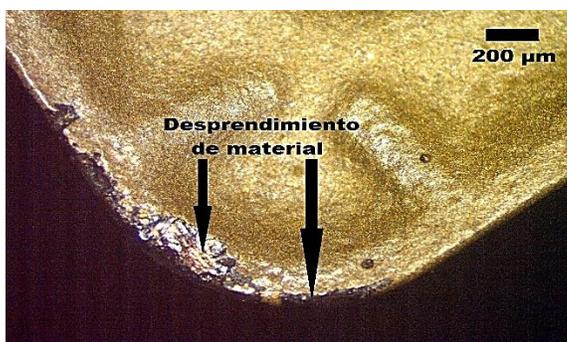
Figura 47 Microscopia óptica inserto v.s. acero SAE 1018 a 50x en condición seca
