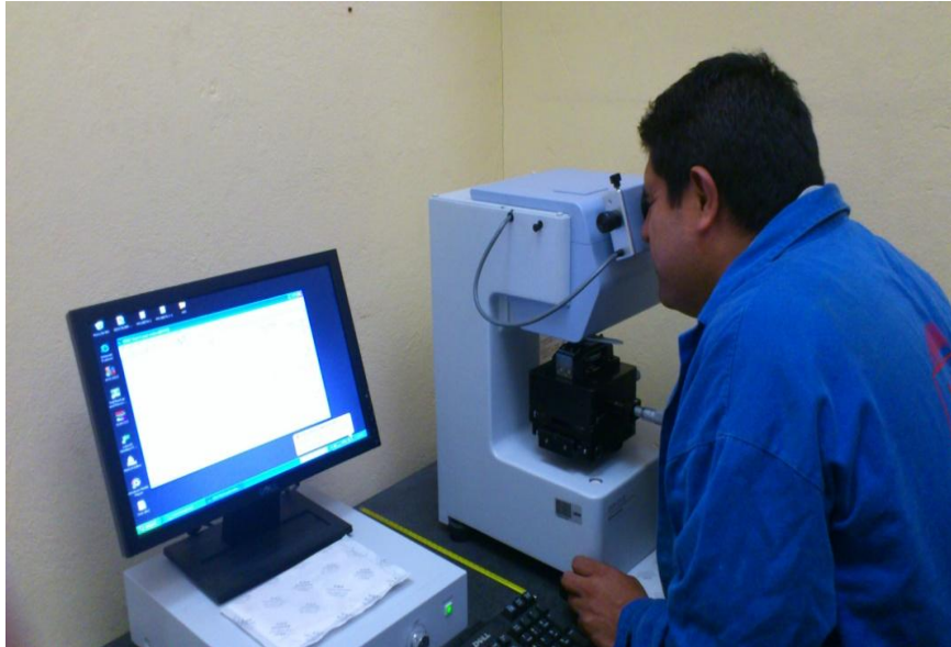
Figura 3.11. Ensayo de nanoindentación mediante el equipo Tester Mitutoyo.
