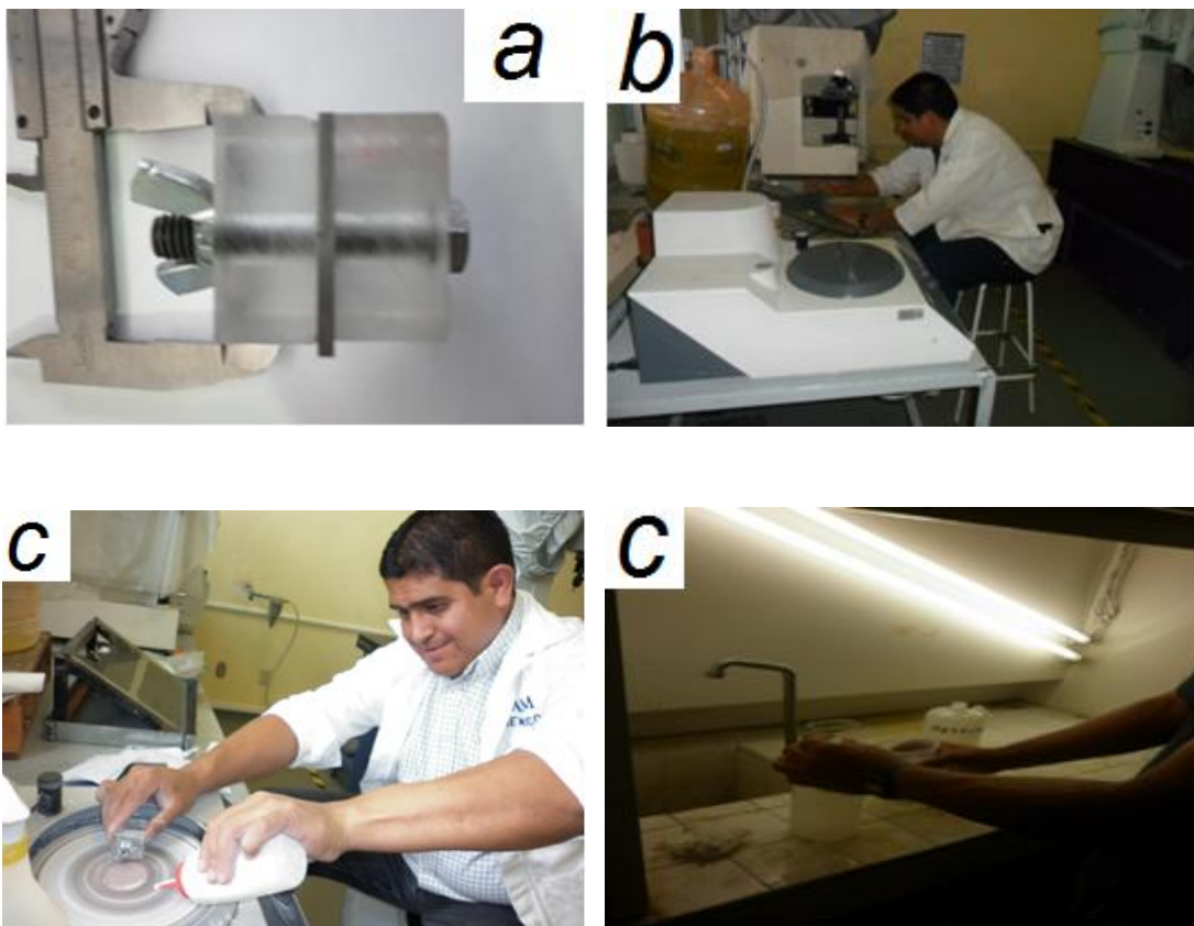
Figura 3.6. Examen metalográfico en cada espécimen; (a) dispositivo para los especímenes; (b) Desbasté grueso y fino; (c) Pulido y (d) Ataque químico por emersión
