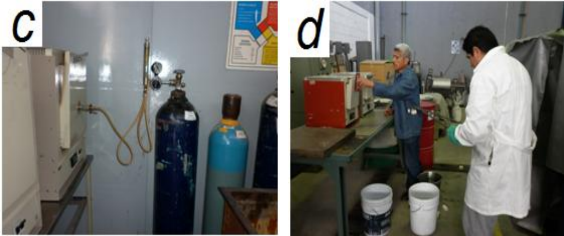
Figura 3.4. Procedimiento del tratamiento de precipitación (a) colocación de especímenes en la mufla; (b) distribución de los especímenes en la mufla; (c) inyección de gas inerte y (d) enfriamiento en agua
