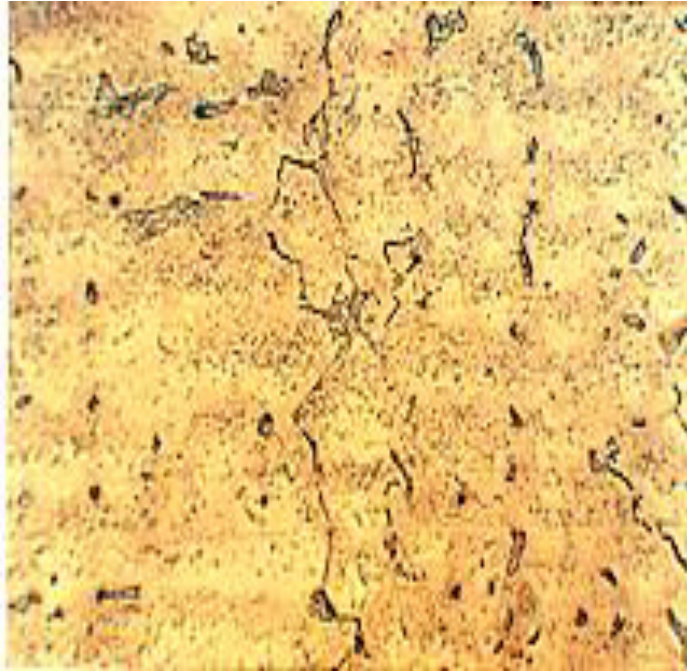
Figura V.2.- Muestra inicial de acero 310L a 400X. Se puede observar una estructura equiaxial de matriz austenítica con carburos de Cromo intercristalinos en los límites de grano
