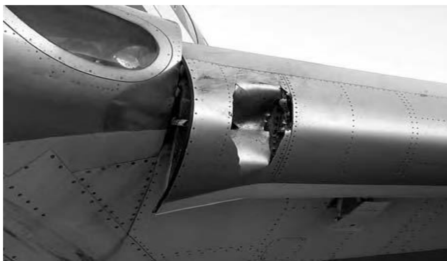
Figura IV.2.- Fractura de la chapa del ala de un jet de pasajeros [Arana y González, 2001]
