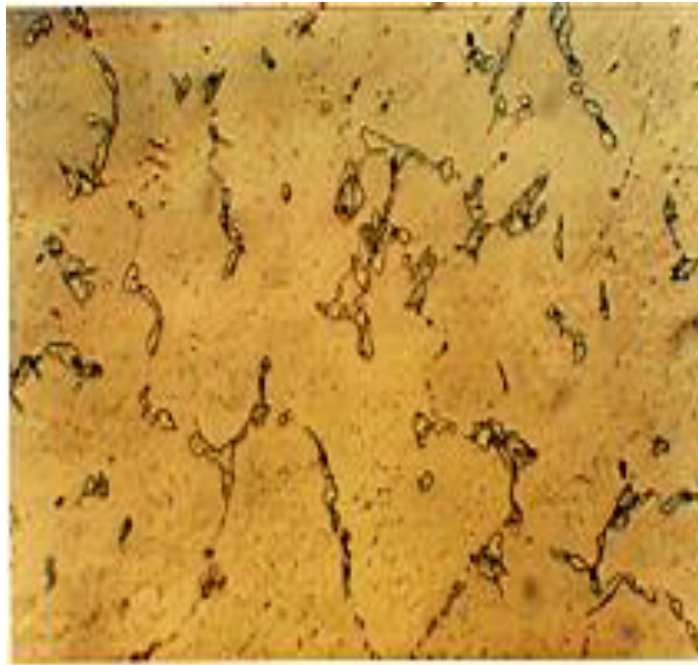
Figura V.6.- Muestra de acero 310L a 1200 horas, 400X. La austenita nuevamente sufre un cambio, observándose que vuelve aparecer el carburo del tipo M_{23}C_6 .
