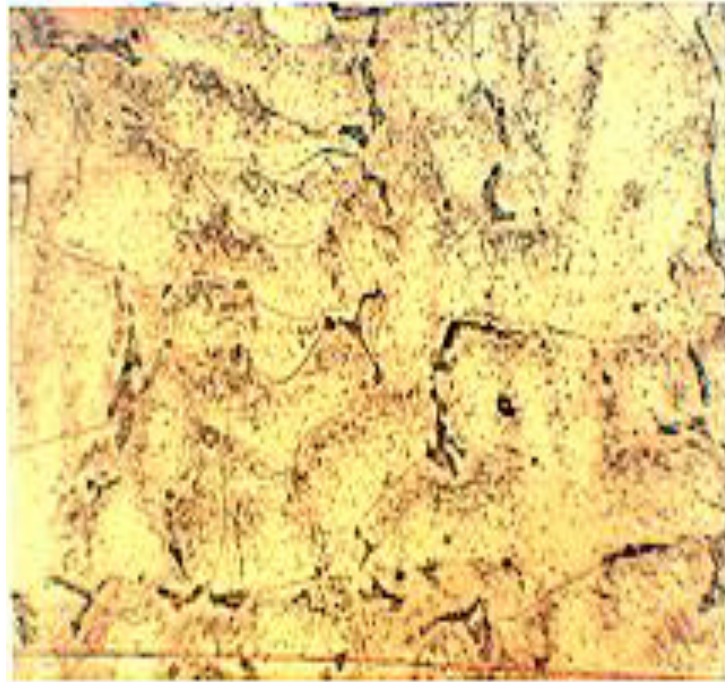
Figura V.4.- Muestra de acero 310L a 600 horas, 400X. Se observa un cambio de estructura, en donde el carburo tiende a diluirse por el efecto del calentamiento y del enfriamiento rápido.
