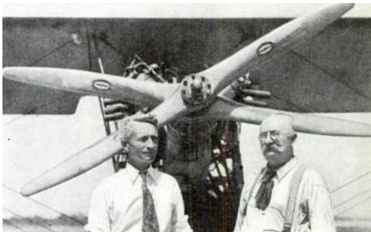
Figura 1.2.1-1 Juego de propelas contra-rotativas (1931) 2
