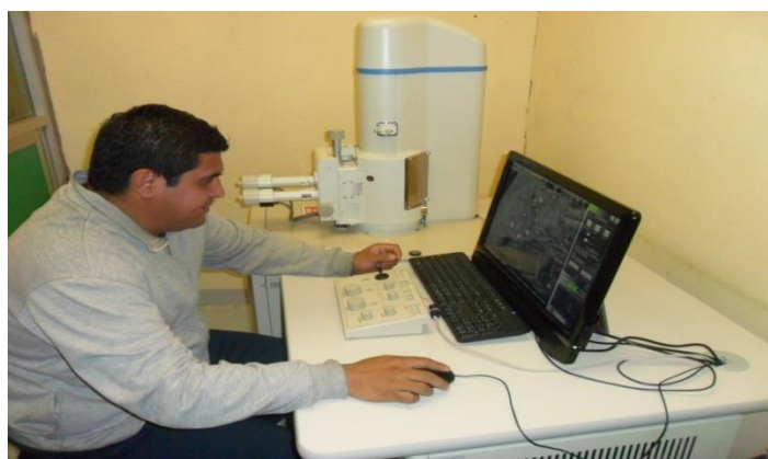
Figura 3.8. Ensayo de EDS del acero API-X60
