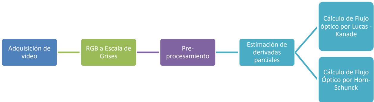
**Figura 4.1** Diagrama de obtención de Flujo Óptico.
