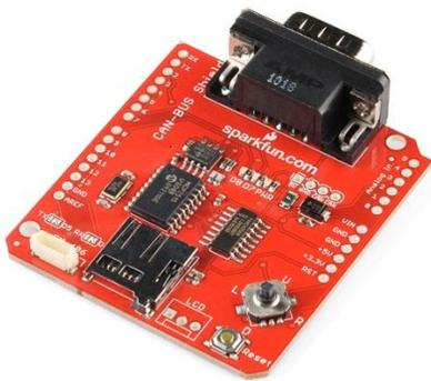
Ilustración 6-4 Can-Bus Shield.
