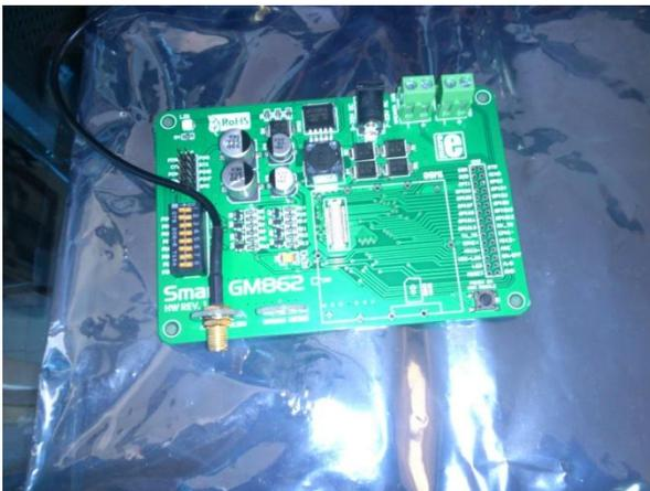
Ilustración 6-9 Antena GPS
