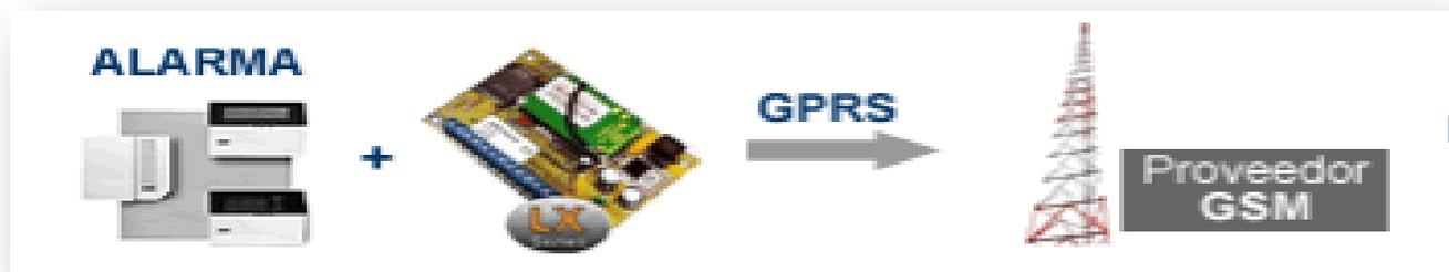
Ilustración 4-2 Arquitectura Física del sistema.
