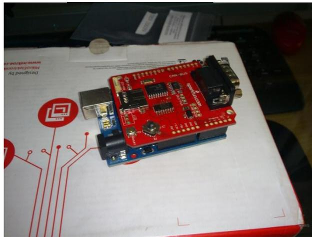
Ilustración 6-8 Arduino ensamblado con el Shield can-bus.
