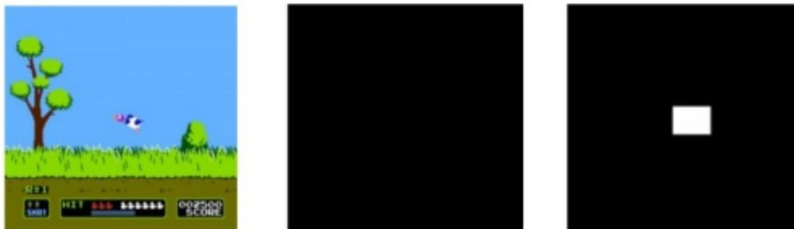
Figura 1.15: Funcionamiento de la pistola Zapper.
