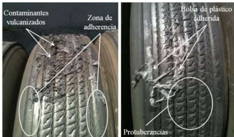
Fig. 1.4. Neumáticos del STCMetro con contaminantes.
