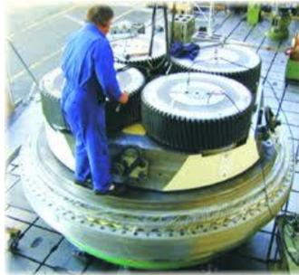
Figura 1.22. Mecanismo de orientación [32]
