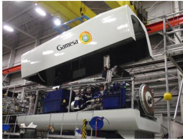
Figura 1.16. Góndola de un aerogenerador [26]
