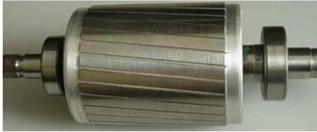
Figura 2.1. Rotor de polos lisos [45]
