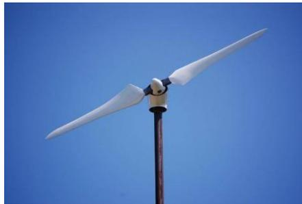
Figura 1.11. Aerogenerador de dos palas [21]
