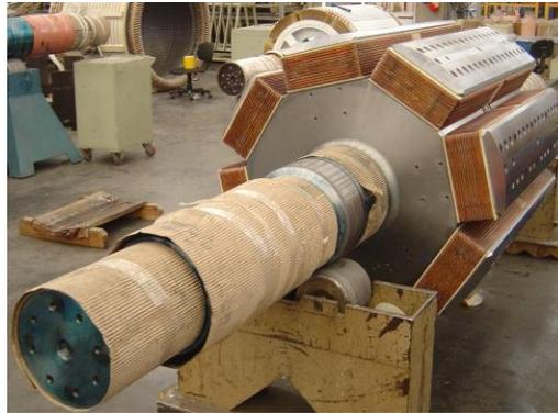
Figura 2.2. Rotor de polos salientes [46]
