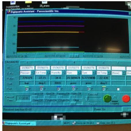
Figura 35: Lecturas de presión atmosférica, humedad relativa y temperatura.
