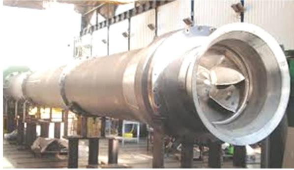
FIGURA 1.4 BOMBAS VERTICALES DE TURBINA CON EL MOTOR POR ENCIMA
