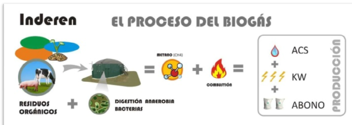
Figura 2. Proceso de la Digestión Anaerobia.
