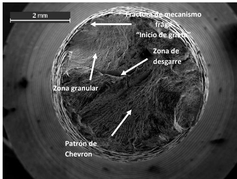
Figura 4.13 Fractografía de probeta de acero AISI H13 (7AP) a una magnificación de 16X.
