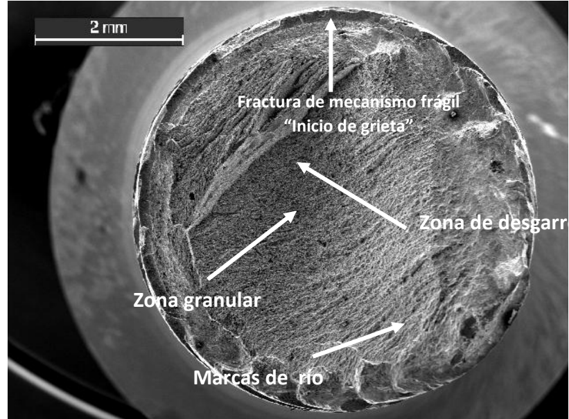
Figura 4.12 Fractografía de probeta de acero AISI H13 (7A) a una magnificación de 16X.
