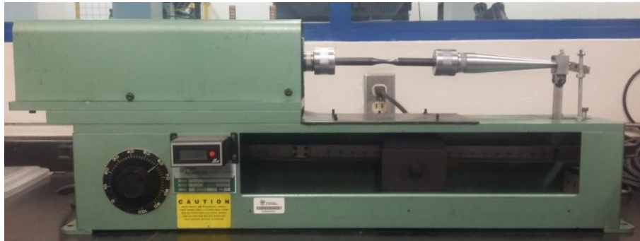
Figura 3.10 Máquina para ensayo de fatiga por viga rotatoria en voladizo Fatigue Dynamics RBF-200HT .
